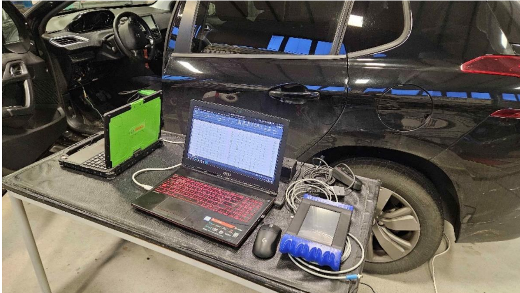
Figura 4-6 - Instrumentação utilizada para decodificar o ângulo de direção
