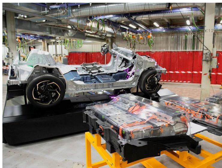
Figura 6-6 - Bateria dividida em módulos [30]
