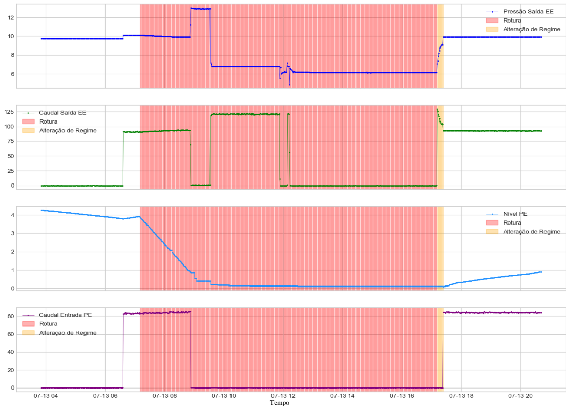
Figura 99 - Rotura em 13-07-2019 seguida de carregamento de conduta (pressão em bar, nível em metros e caudal em m 3 /h)
