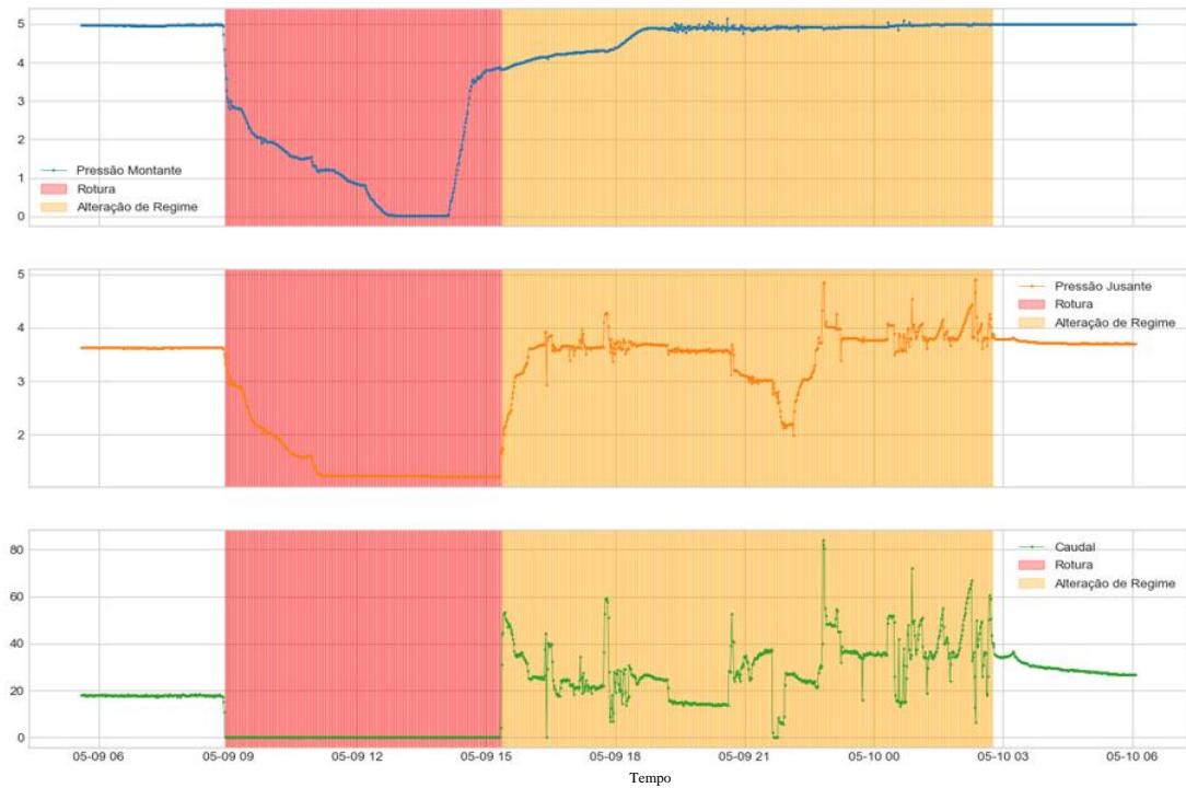
Figura 80 - Rotura seguida de carregamento da conduta em 09-05-2022 (pressão em bar e caudal em m 3 /h)
