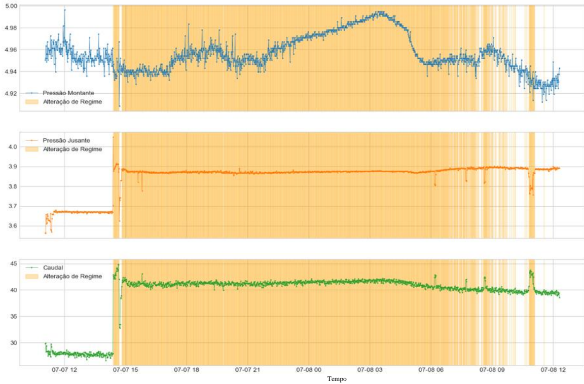
Figura 88 - Alteração de regime entre 07-07-2022 e 08-07-2022 (pressão em bar e caudal em m 3 /h)
