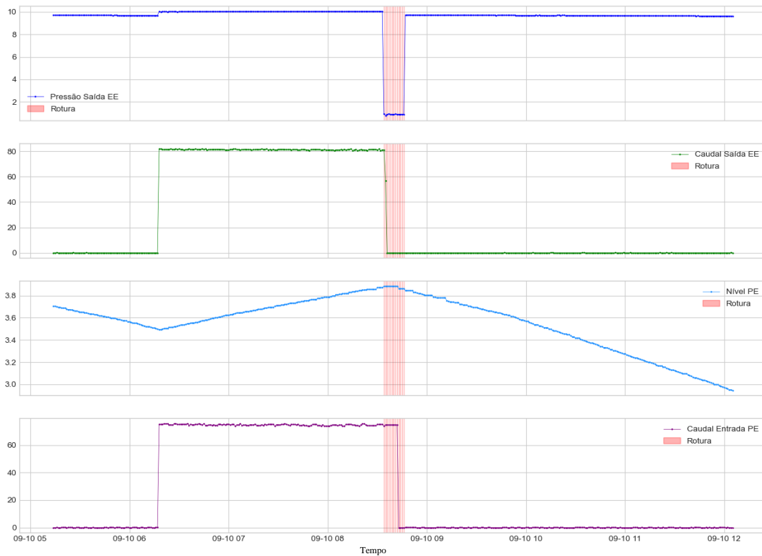
Figura 104 - Evento de perda de pressão em 10-09-2019 compatível com condições de rotura (pressão em bar, nível em metros e caudal em m 3 /h)
