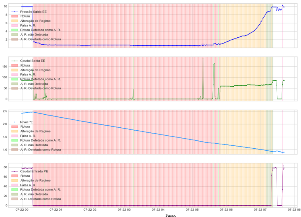
Figura 74 – Representação gráfica dos parâmetros da rotura ocorrida em 22 de julho de 2022 (pressão em bar, nível em metros e caudal em m 3 /h)
