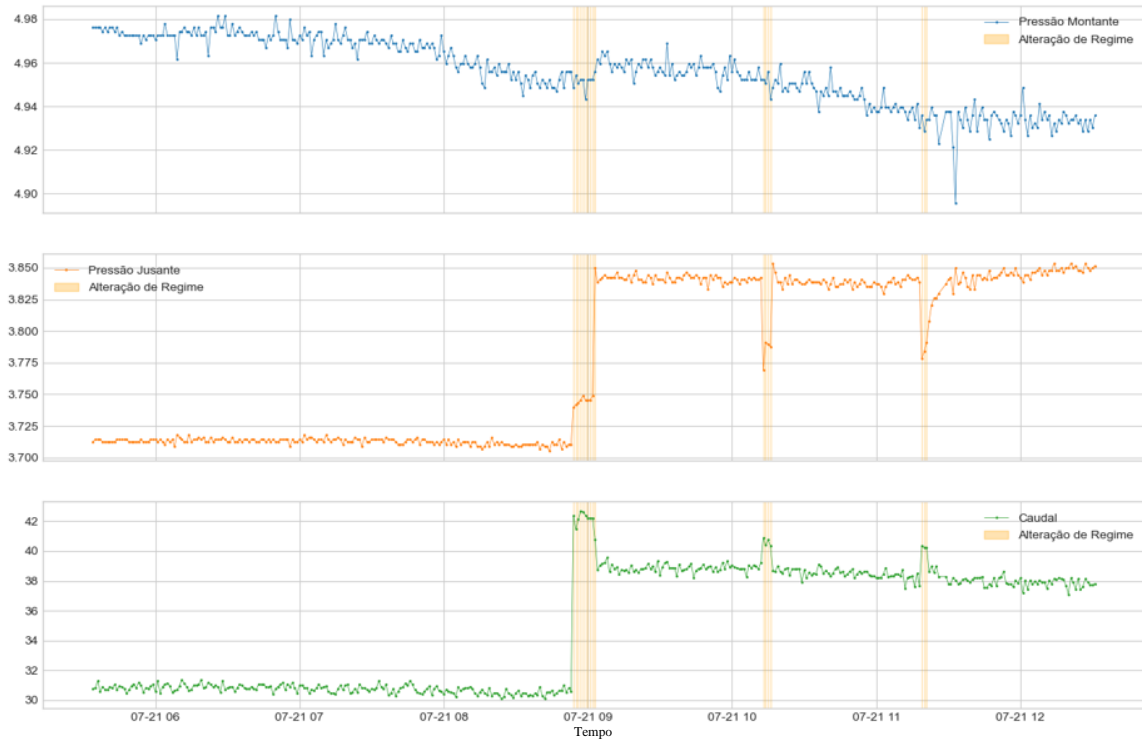
Figura 90 - Alterações de regime em 21-07-2022 (pressão em bar e caudal em m 3 /h)
