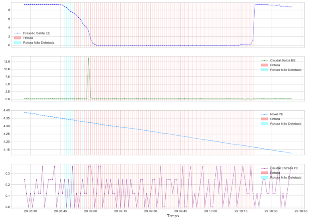
Figura 73 – Perdas de pressão na compressão dos grupos devido à realização de trabalhos na instalação (pressão em bar, nível em metros e caudal em m 3 /h)
