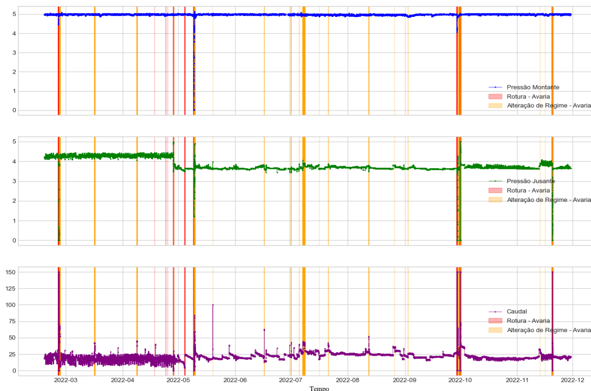
Figura 31 - Representação gráfica da classificação dos dados de teste pelo algoritmo XGBoost (pressão em bar e caudal em m 3 /h)
