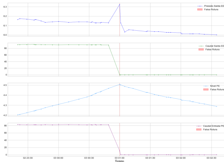
Figura 61 – Pico de pressão não classificado que foi encontrado pelo algoritmo (pressão em bar, nível em metros e caudal em m 3 /h)
