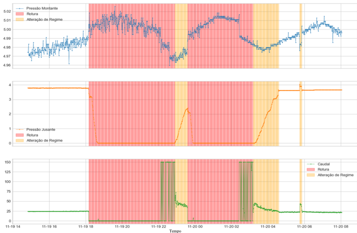
Figura 95 - Rotura em 19-11-2022 seguida de carregamento de conduta, nova rotura seguida e carregamento da conduta (pressão em bar e caudal em m 3 /h)
