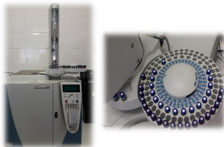
Figura 16 – Análise dos FAMES no cromatógrafo gasoso (GC) Finnigan Ultra Trace
