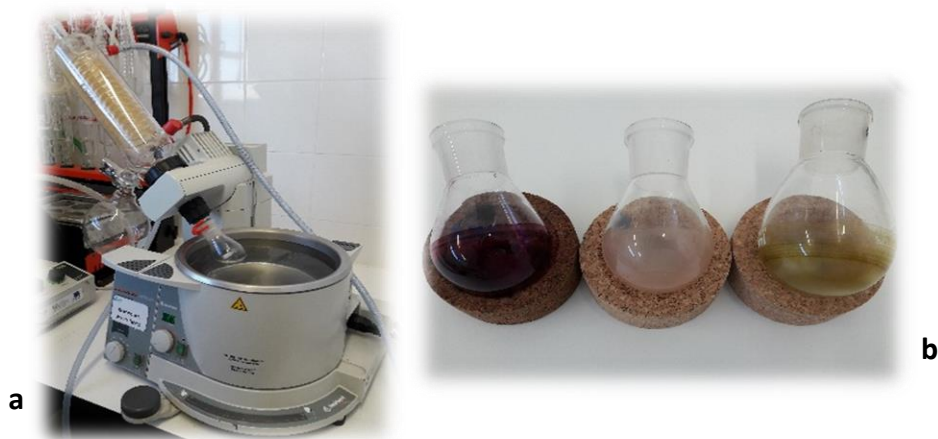
Figura 23 – Extração no rotavapor Laborota 4000 (a) e identificação dos balões da polpa, semente e folha de Myrtus spp. após a extração do solvente etanol a 70 % v/v (b)
