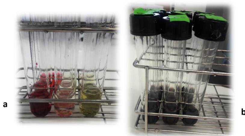
Figura 15 – Amostras de polpa, semente e folha de murta sob catálise ácida (2 mL de H 2 SO 4 a 2% (v/v) em metanol) (a) e, amostras após 5 minutos de centrifugação a 1000 rpm, com sobrenadante contendo os esteres metílicos de ácidos gordos (FAME's) (b)
