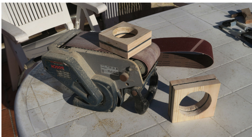
Fig. 42 - Lixagem das peças de madeira com lixa elétrica de rolo.
