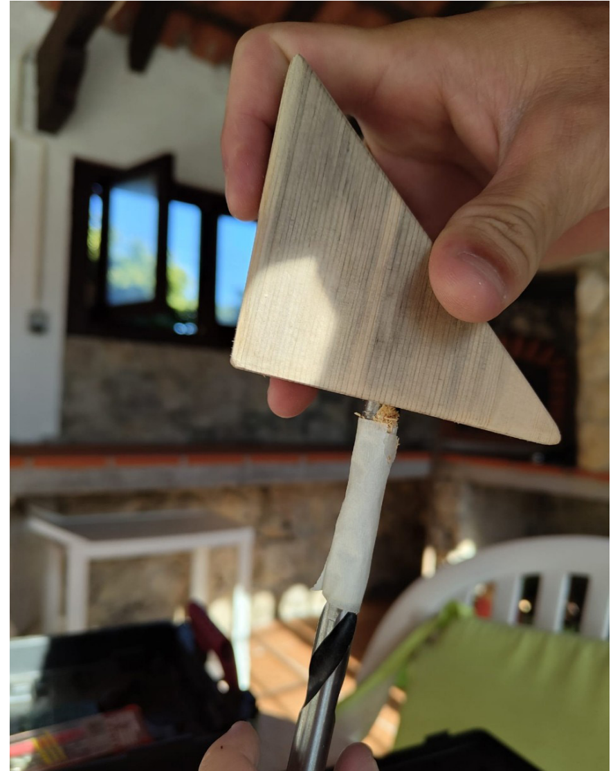
Fig. 48 - Perfuração com berbequim e com broca de 10mm para posterior encaixe dos ímanes.
