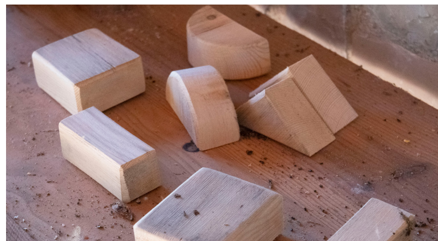
Fig. 27 - Resultado final das peças após a marcação, corte e lixagem.
