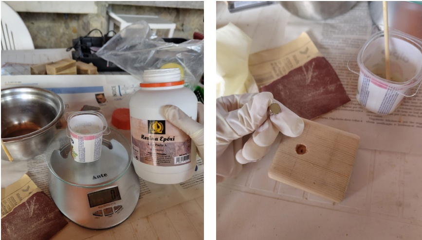
Fig. 47a e 47b - Mistura da resina e a sua aplicação.
