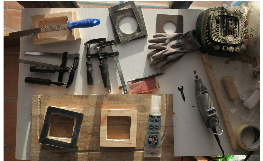
Fig. 39 - Preparação para aplicação da cola: as superfícies de madeira e metal são ajustadas e organizadas antes da colagem.
