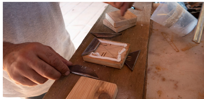
Fig. 29a e 29b - Execução das primeiras peças "base A e B" e a sua respetiva colagem.
