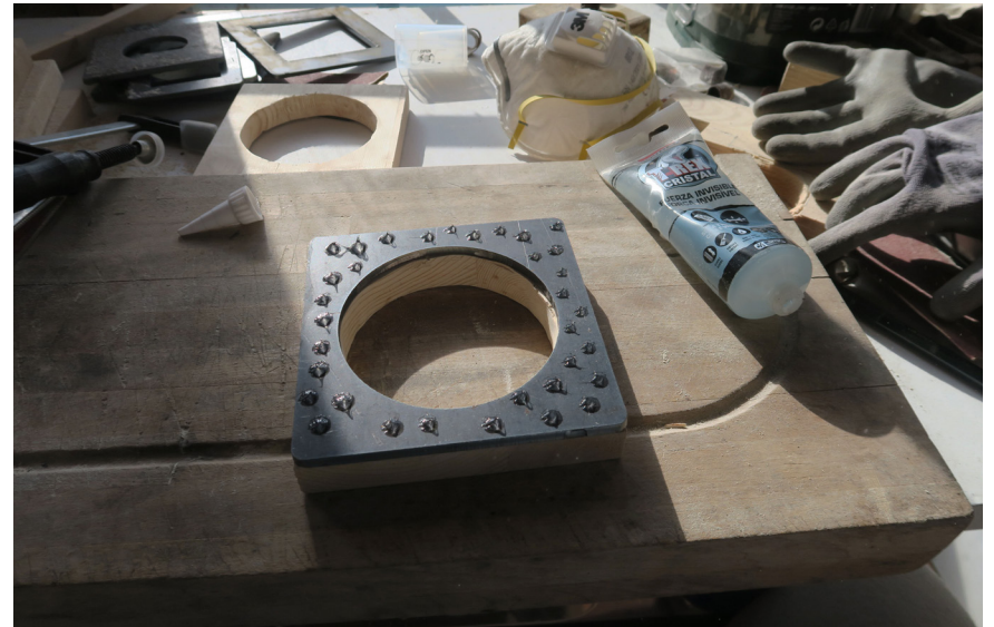
Fig. 40 - Aplicação da cola em gotas. A cola é distribuída em pontos estratégicos para permitir a passagem de ar entre as peças, garantindo uma aderência mais eficaz.
