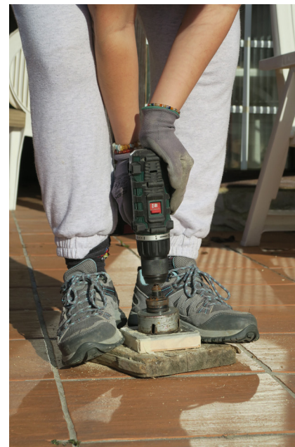
Fig. 36a e 36b - Perfuração das peças de madeira com berbequim, realizada para garantir a precisão dos furos circulares e a correta instalação dos componentes.
