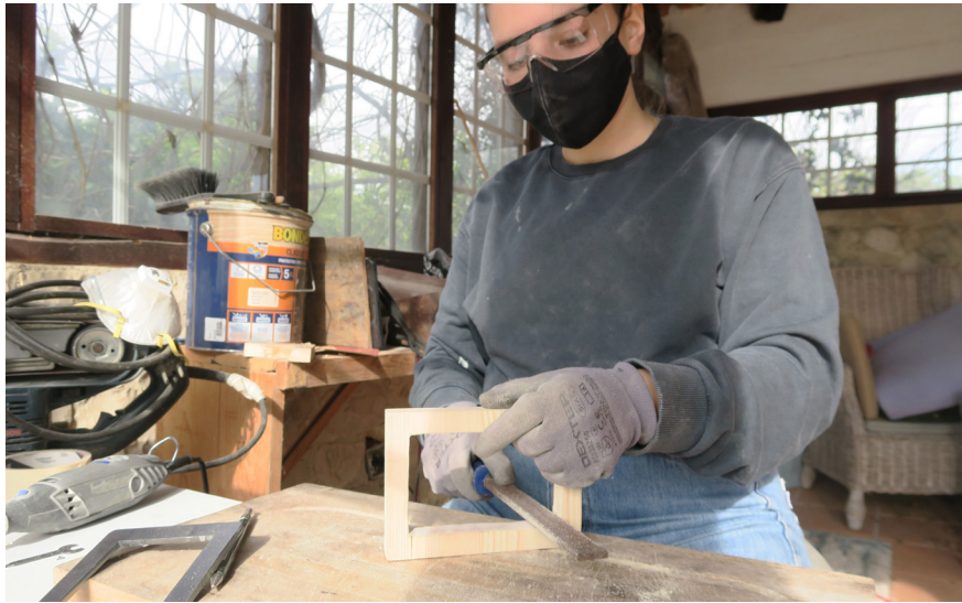
Fig. 38 - Para as peças com furo retangular, o interior foi lixado com o formão para definir melhor as arestas.
