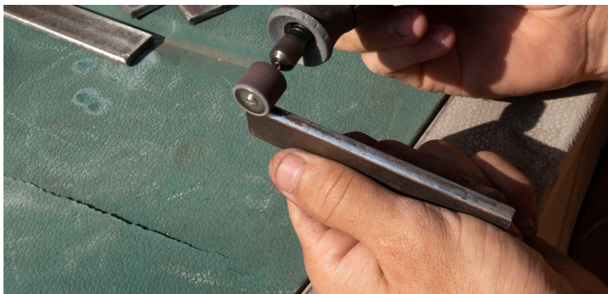
Fig. 28a e 28b - Lixamento e polimento das arestas e faces do perfil de metal.
