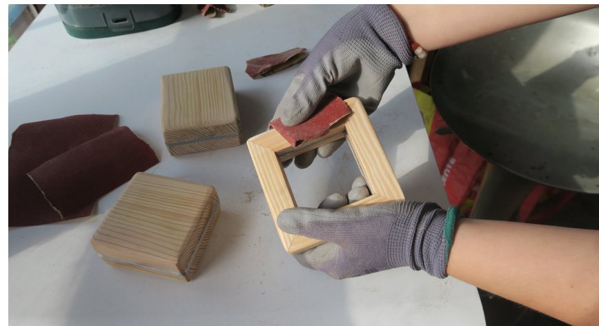
Fig. 43 - Lixagem manual das peças, utilizando lixa de grão 80, 100 e 120, para suavizar e uniformizar a superfície da madeira.
