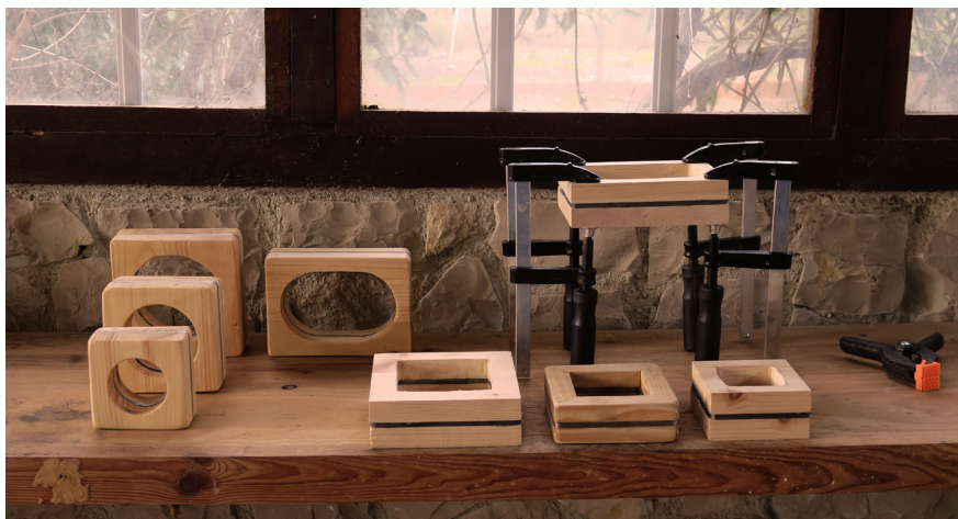
Fig. 41 - Colagem das peças metálicas às de madeira, com um tempo de secagem de 24 horas. Conjunto dos "corpos base".
