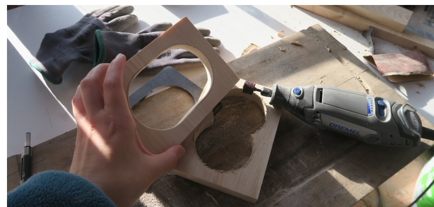
Fig. 37 - Ajuste de detalhes nas peças de madeira com a Dremel para um acabamento preciso.
