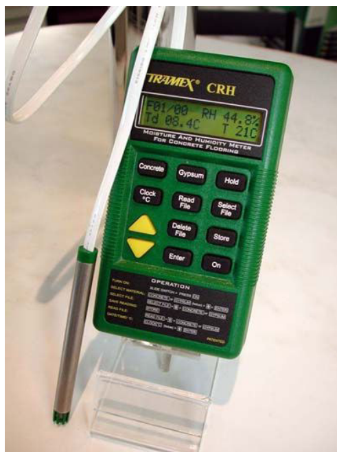
Figura 48 – Humidímetro marca “TRAMEX CRH” (Fattore Vitale & Co., 2008)
