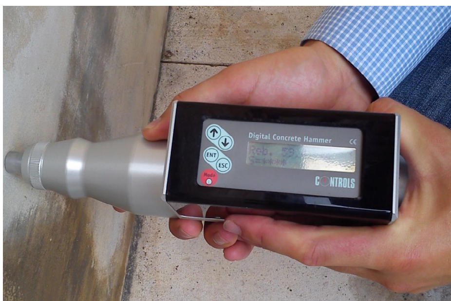
Figura 50 - Esclerómetro de Schmidt digital usado nos ensaios
