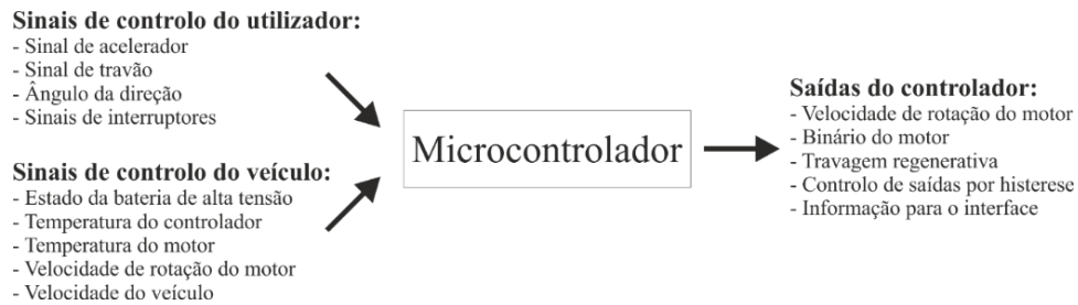
Figura 2.2 - Sinais de entrada e de saída típicos de um inversor [2].
