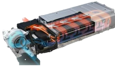
Figura 2.11 - Pack de baterias do Toyota Prius [17].
