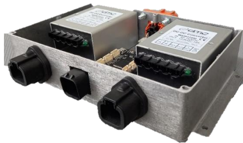
Figura 4.17 - Caixa dos conversores DC/DC.
