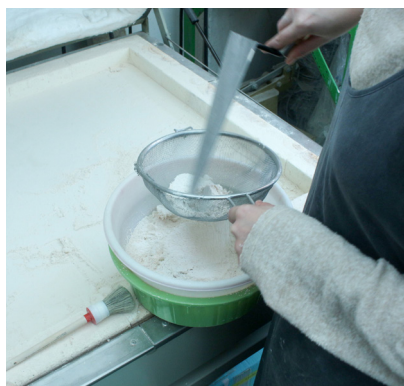
fig. 48 | Separar resíduos do pó refratário
