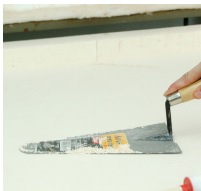
fig. 47 | Retirar resíduos do fundo do forno
