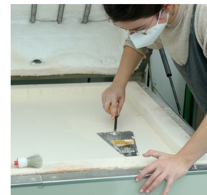
fig. 50 | Alisar a base do forno
