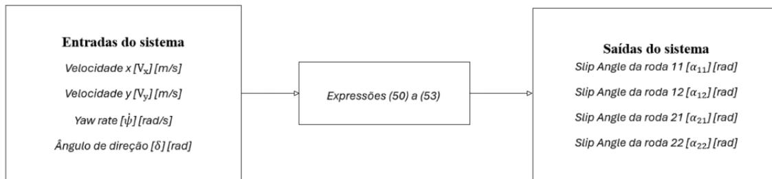
Figura 40 - Esquema de funcionamento do modelo de cálculo do slip angle .
