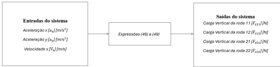
Figura 38 - Esquema de funcionamento do modelo de cargas verticais.
