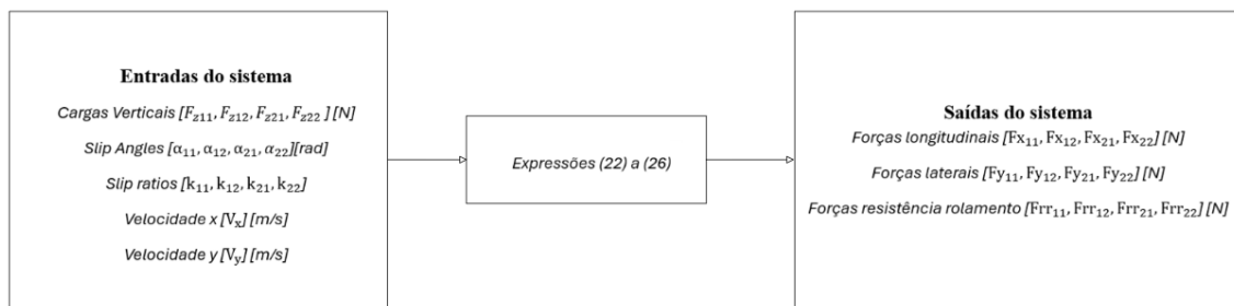
Figura 49 - Esquema de funcionamento do modelo da fórmula mágica.
