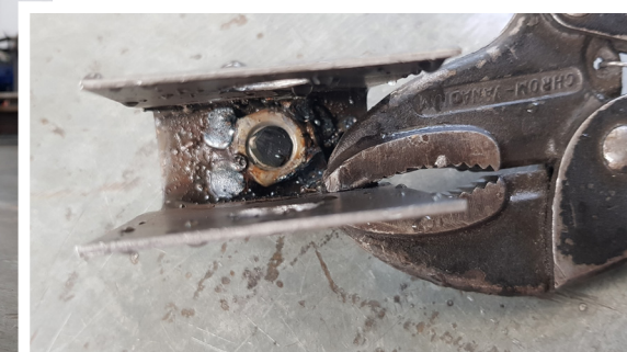
Fig. 87 - Pormenor de fixação da roldana.
