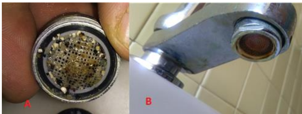
Figura 1 – “A”: interior do filtro com um biofilme formado no centro; “B”: torneira com um filtro sujo devido a óxido de ferro.
