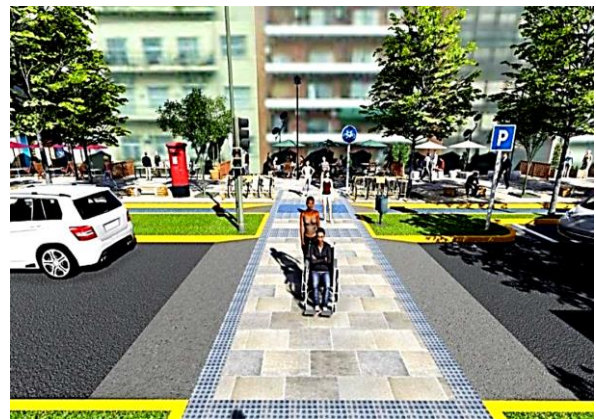
Figura 4-8. Plataformas, ayudan en el cruce de personas vulnerables, reducir la velocidad y evita la invasión por parte de los vehículos [44].
