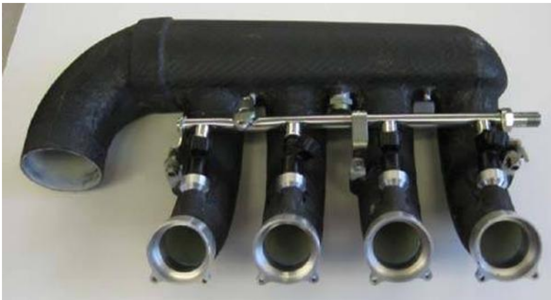
Figura 2 - coletor de admissão completo, Ilardo, R et al, 2010
