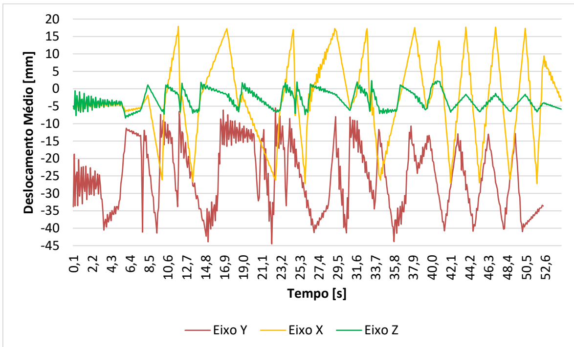
Figura 88 – Gráfico do deslocamento médio em cada eixo para a massa não-suspensa traseira esquerda no evento Autocross - 1º Caso
