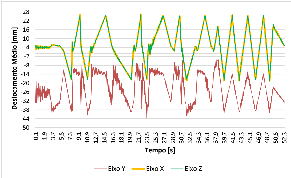
Figura 87 – Gráfico do deslocamento médio em cada eixo para a massa não-suspensa traseira direita no evento Autocross - 1º Caso
