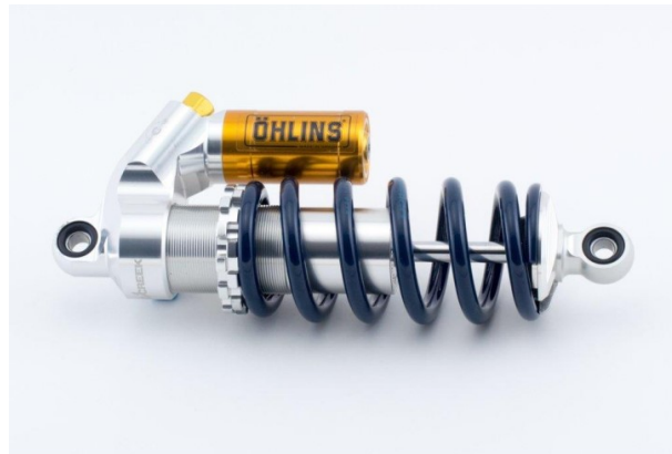
Figura 8 – Amortecedor TTX25 – Ohlins (Gomes & Pinto, 2019)
