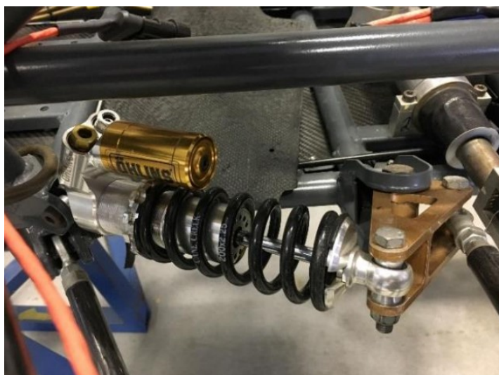
Figura 29 – Conjunto mola-amortecedor instalado no FSIPLEiria (Gomes & Pinto, 2019)
