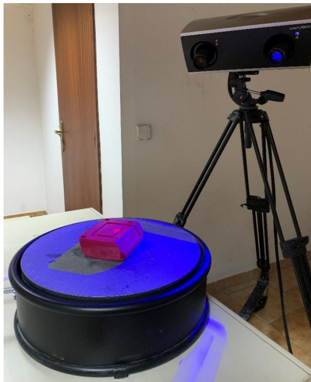
Figura 45 – Controlo dimensional de um bloco moldante
