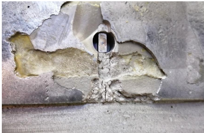
Figura 58 – Desgaste após 1080 moldações
