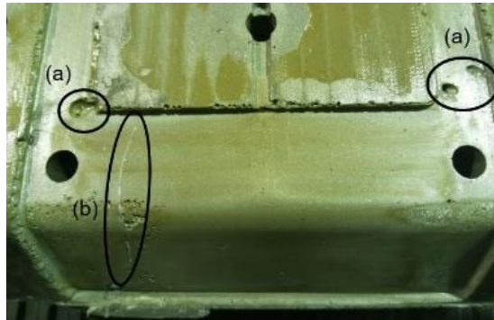
Figura 52 – Desgaste após 1750 moldações: (a) Deterioração Superficial; (b) Fissura Superficial
