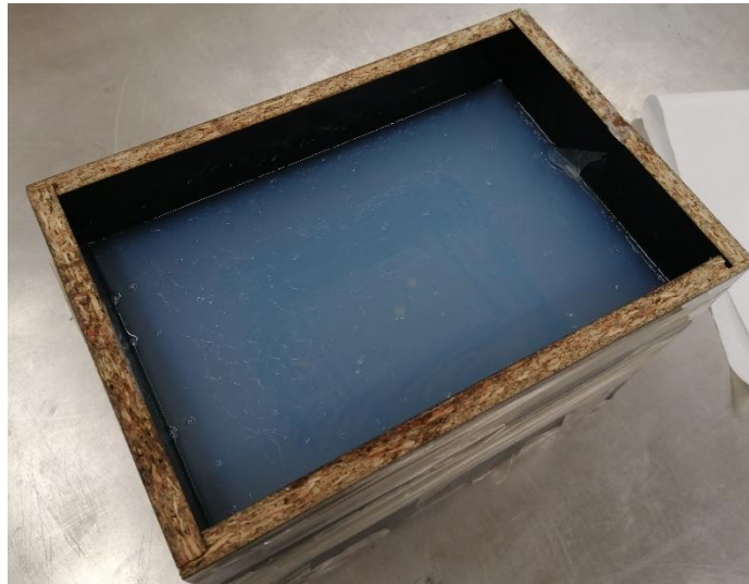
Figura 39 - Molde de silicone durante o processo de cura
