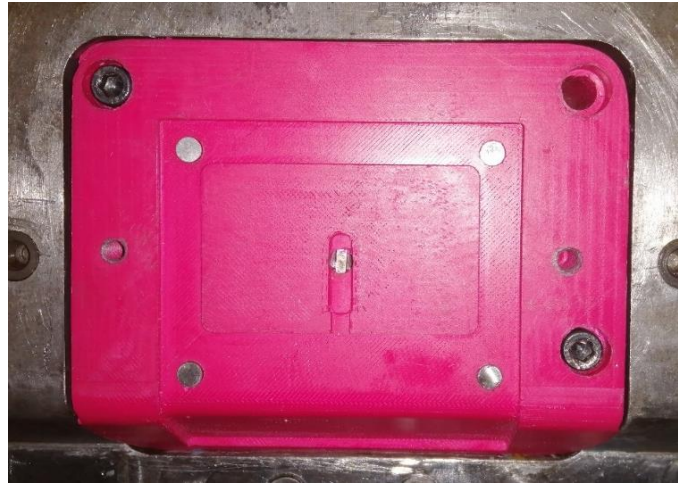
Figura 62 - Bloco FDM ajustado à chapa do molde
