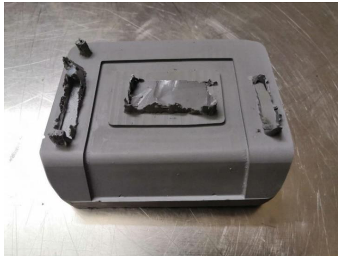
Figura 40 - Bloco moldante com pó de alumínio obtido
