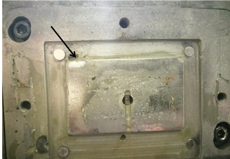
Figura 60 - Fratura da extremidade no canto superior esquerdo
