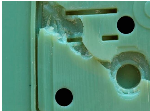
Figura 21 - Desgaste da bucha resultante da remoção progressiva de partículas (Bagalkot, Pons, Symons, & Clucas, 2019)
