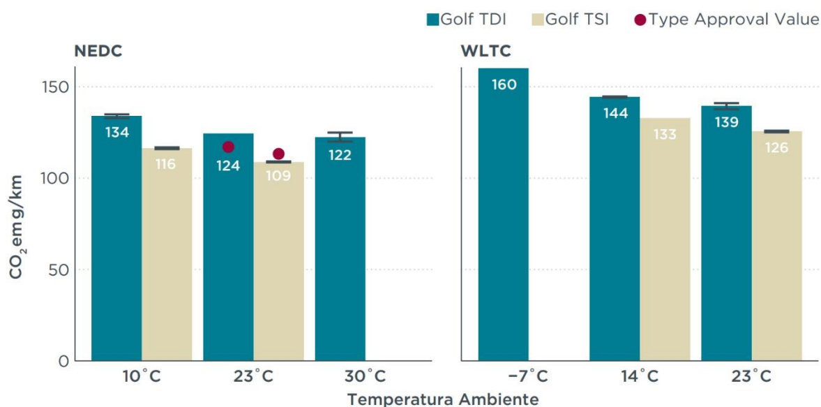
Figura 10: Efeito da temperatura ambiente nas emissões de \text{CO}_2 durante o arranque a frio nos ciclos WLTC e NEDC. Adaptado de: (Dornoff & Rodríguez, 2019)
