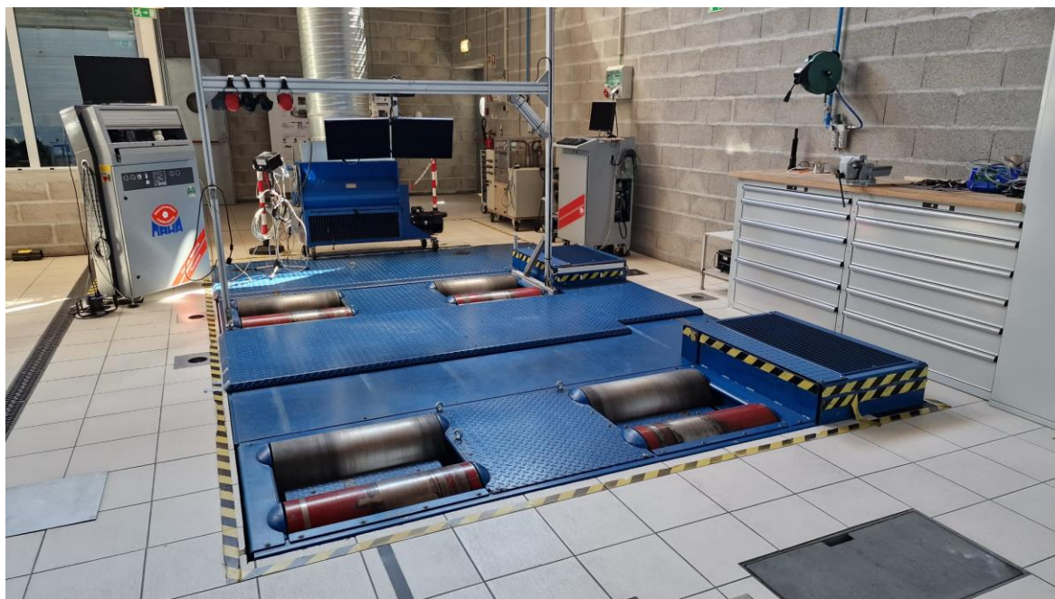
Figura 14 - Imagem do banco de ensaio de veículos instalado no Laboratório de Engenharia Automóvel do Instituto Politécnico de Leiria.
