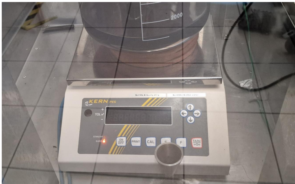
Figura 17: Sistema utilizado para medição do consumo e temperatura de combustível nos ensaios realizado em dinamómetro.
