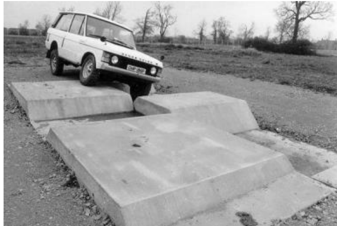
Figura 8 – viatura a passar por cima de um obstáculo com 1 roda de cada vez (Jason C. Brown, 2002)
