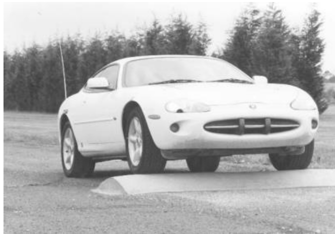
Figura 7 – Viatura a passar por cima de uma lombada com as duas rodas ao mesmo tempo (Jason C. Brown, 2002)
