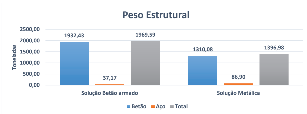
Figura 37 - Peso estrutural de ambas as soluções estruturais
