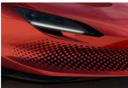
Figura 4 - Grelha frontal produzida através do fabrico aditivo (Autonews, 2020)
