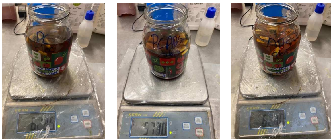
Figura 90 - Registo da massa de óleo em provetes dos vários materiais
