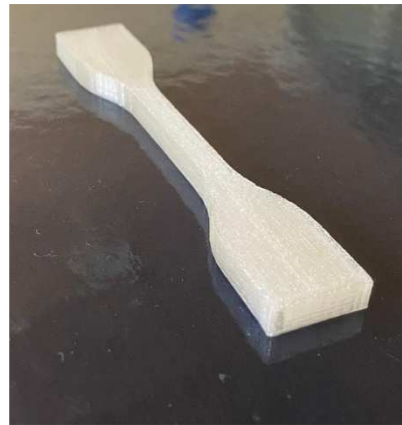
Figura 44 – Provete produzido na horizontal, sem suportes
