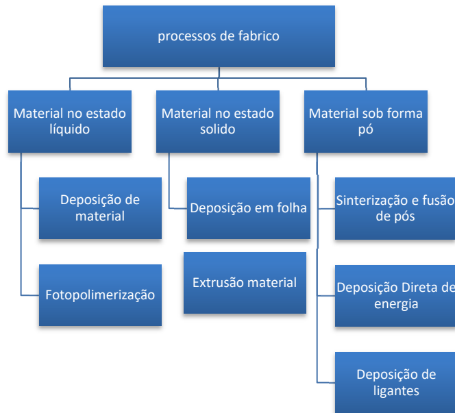
Figura 5 - Processos de fabrico aditivo segundo a norma ASTM F42, por estado de material (A. Ahmadi Nadooshan, 2007)
