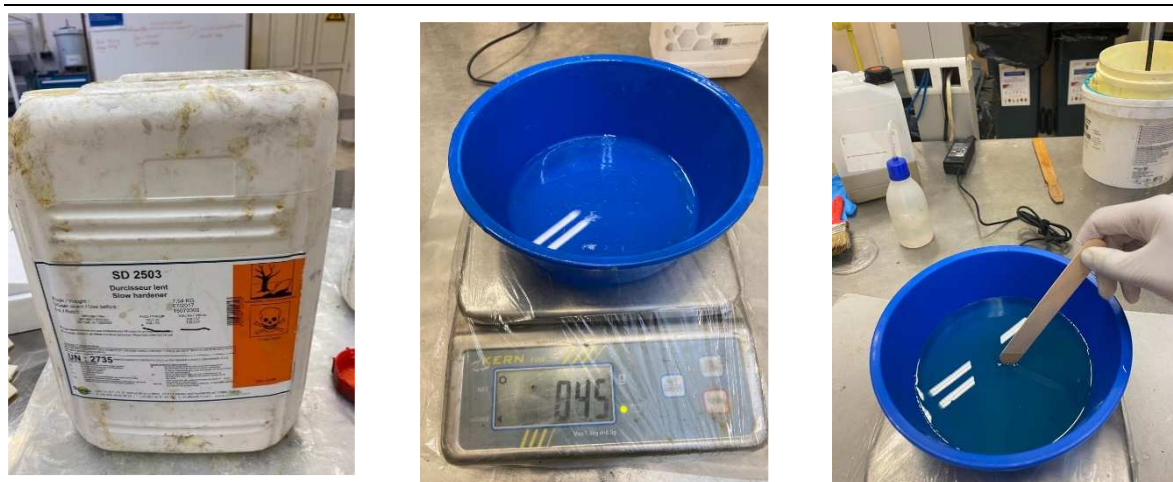
Figura 57 – Adição da massa de endurecedor respeitando a relação indicada
