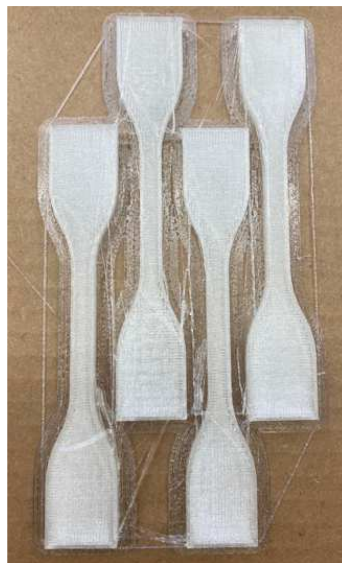
Figura 45 – conjunto de 4 provetes de PC impressos
