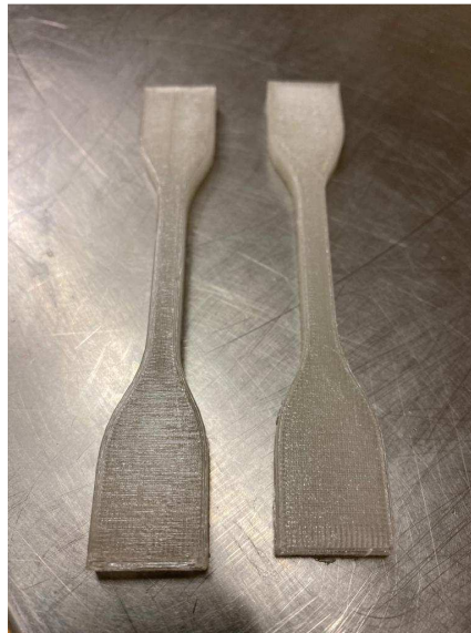
Figura 46 – Comparação do provete com camada de 0.3mm (à esquerda) e 0.15mm (à direita)
