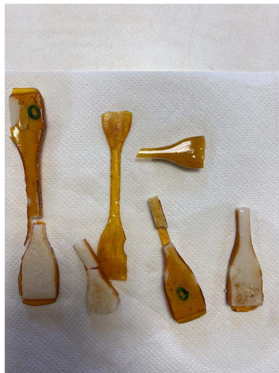
Figura 76 – Provetes em PC revestido mergulhados em óleo
