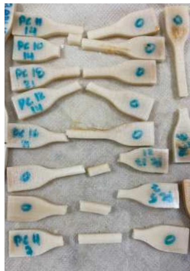
Figura 75 - Provetes em PC não revestido mergulhados em óleo
