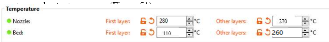
Figura 48 – Temperaturas de impressão para PC-ABS
