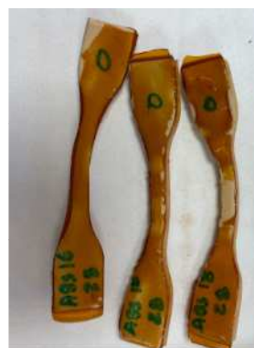
Figura 82 – provetes de ABS revestidos, mergulhados em óleo ao fim do 28º dia
