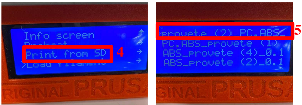
Figura 102 – Procedimentos de impressão na PRUSA MK3S+
