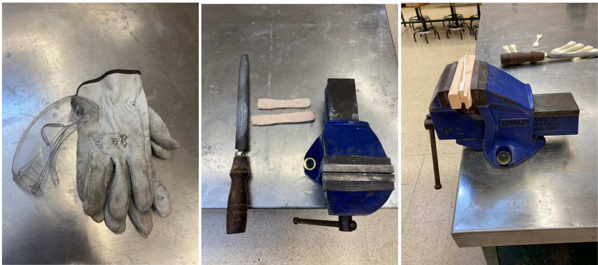
Figura 59 – Material utilizado e disposição do provete no processo de remoção do excesso de resina
