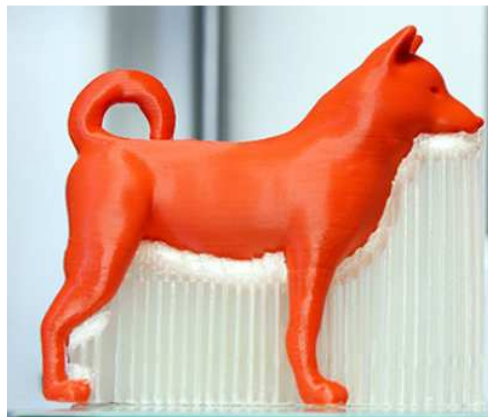
Figura 18 - Peça em fabrico aditivo com suportes (filament2print, 2015)
