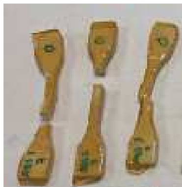
Figura 81 – provete de ABS revestidos, mergulhados em óleo, ao 7º dia
