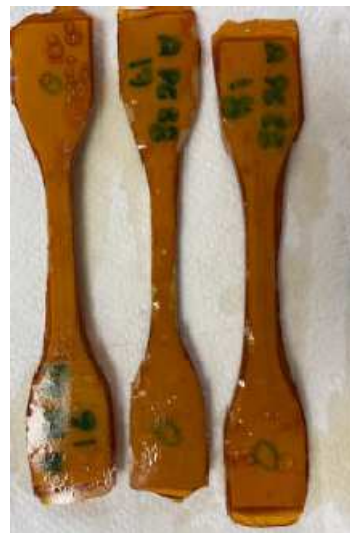
Figura 88 - provetes de PC-ABS revestidos mergulhados em óleo ao fim de 28 dias
