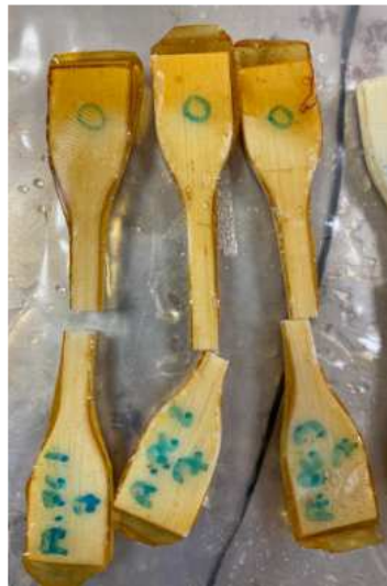
Figura 87 - provetes de PC-ABS revestidos mergulhados em óleo ao fim de 7 dias
