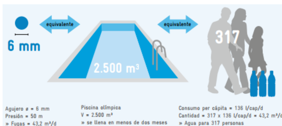
Fig. 21 Interpretación de pérdida de agua a través de un agujero de 6 mm de diámetro y su volumen equivalente de consumo hacia los usuarios
