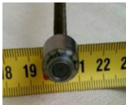
Fig. 34 Videocámara con cabezal de 13 mm con iluminación integrada para diámetro pequeño
