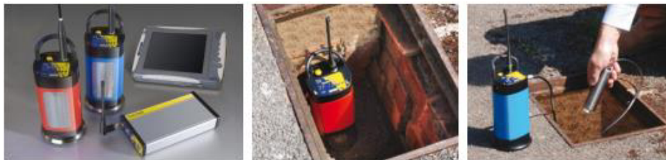
Fig. 38 Utilización de correladores en tuberías
