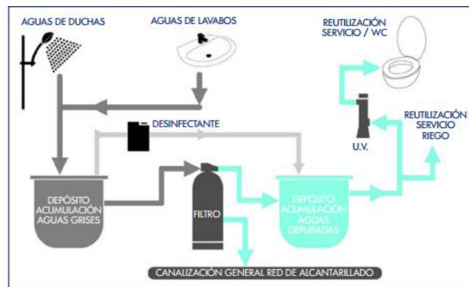
Fig. 58 Sistema de tratamiento físico – químico para reutilización de aguas grises
