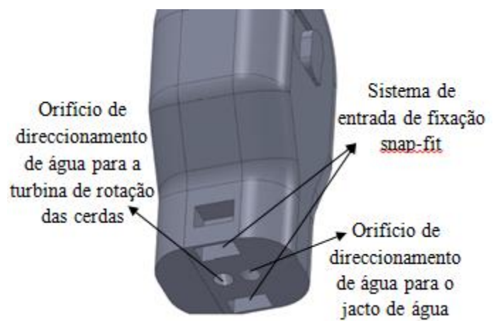
Figura 51: Cabeça da escova de dentes com destaque dos orifícios de condução de água
