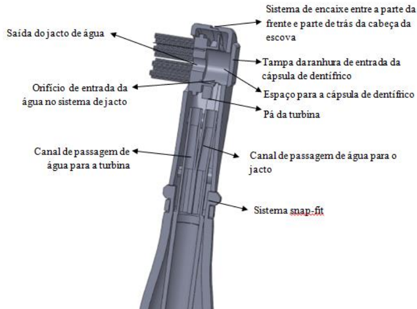
Figura 93: Corte transversal da cabeça da escova de dentes
