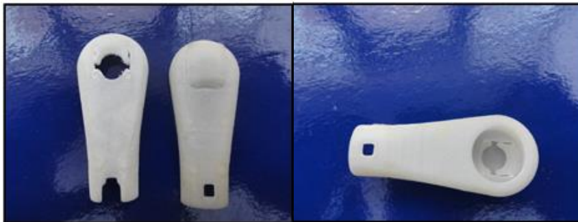
Figura 79: Duas partes de trás da cabeça da escova de dentes da mesma série de impressões, com a única diferença da inclinação dada à peça
