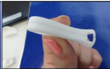
Figura 69: Cabeça da escova de dentes com enfoque na união das duas partes (frente e trás)
