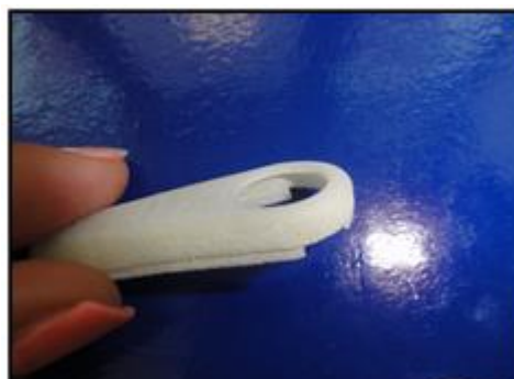
Figura 80: Parte da frente da escova de dentes com destaque da falha na fixação exterior
