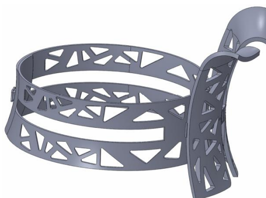
Figura 158: Vista geral do 7º modelo da gargantilha, com destaque da furação triangular
