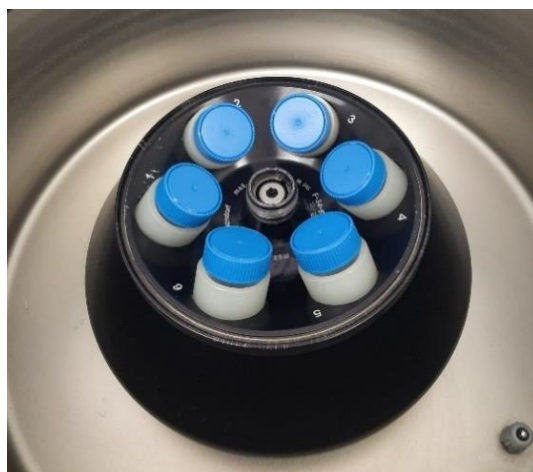
Figura 11- Fotografia representativa dos falcons utilizados na separação de amostras na centrifugadora.
