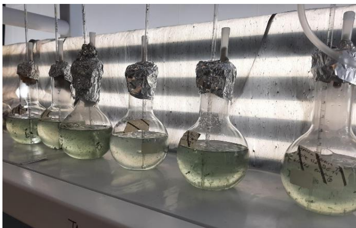
Figura 10- Início do ensaio com Nostoc sp. 136 usando diferentes meios de cultivo.
