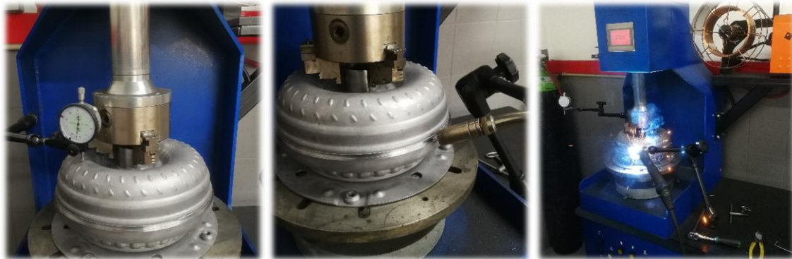
Figura 79 – Procedimento de soldagem do conversor de binário.
