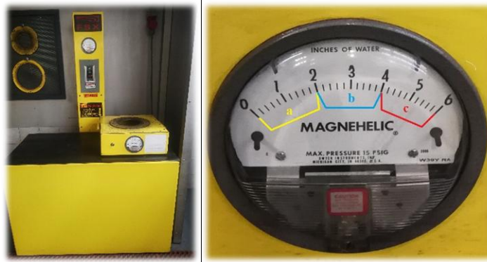
Figura 56 – Banco de teste de obstrução para FAP - a) Baixa, b) Media, c) Excessiva.
