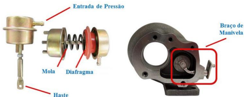
Figura 27 – Atuador pneumático e o braço de manivela (BiagioTurbos, 2021)
