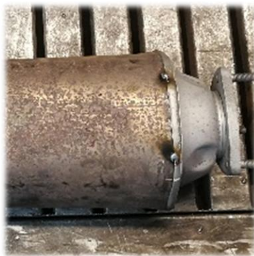
Figura 64 – Fixação das flanges com soldadura MIG.
