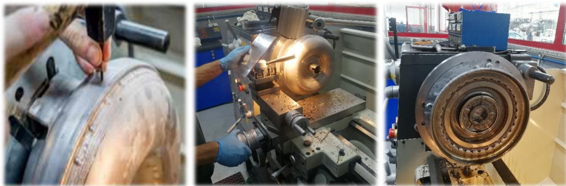
Figura 77 – Abertura do conversor de binário.
