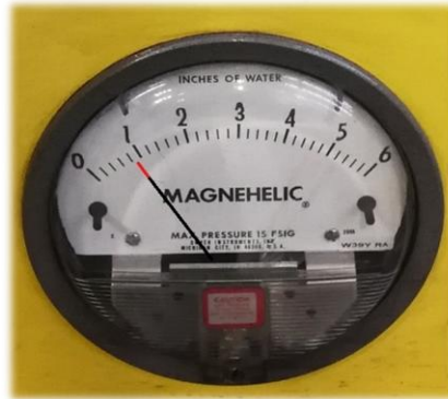
Figura 62 – Terceira medição de fluxo de ar do FAP.
