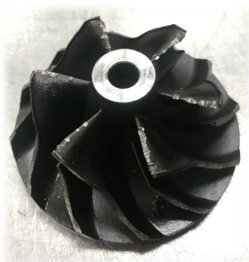
Figura 33 – Desgaste nas pás do compressor.
