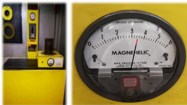
Figura 57 – Primeira medição de fluxo de ar do FAP.
