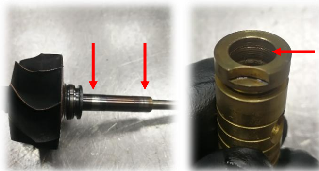
Figura 37 – Folga radial nos componentes do turbocompressor.
