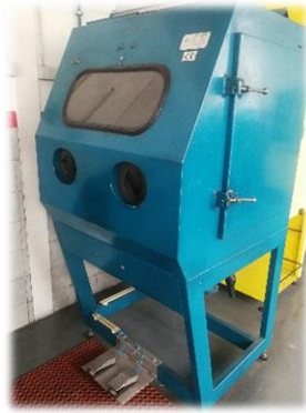
Figura 59 – Equipamento de limpeza manual de ar de alta pressão do catalisador.
