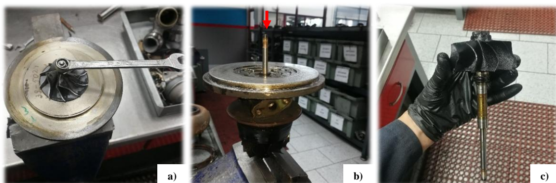
Figura 15 - Desmontagem do compressor e a turbina do corpo central.
