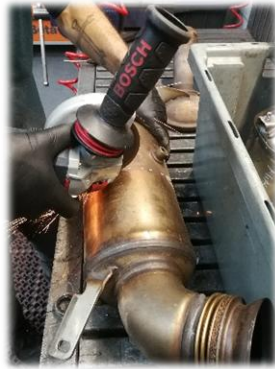
Figura 54 – Separação do FAP e Catalisador.
