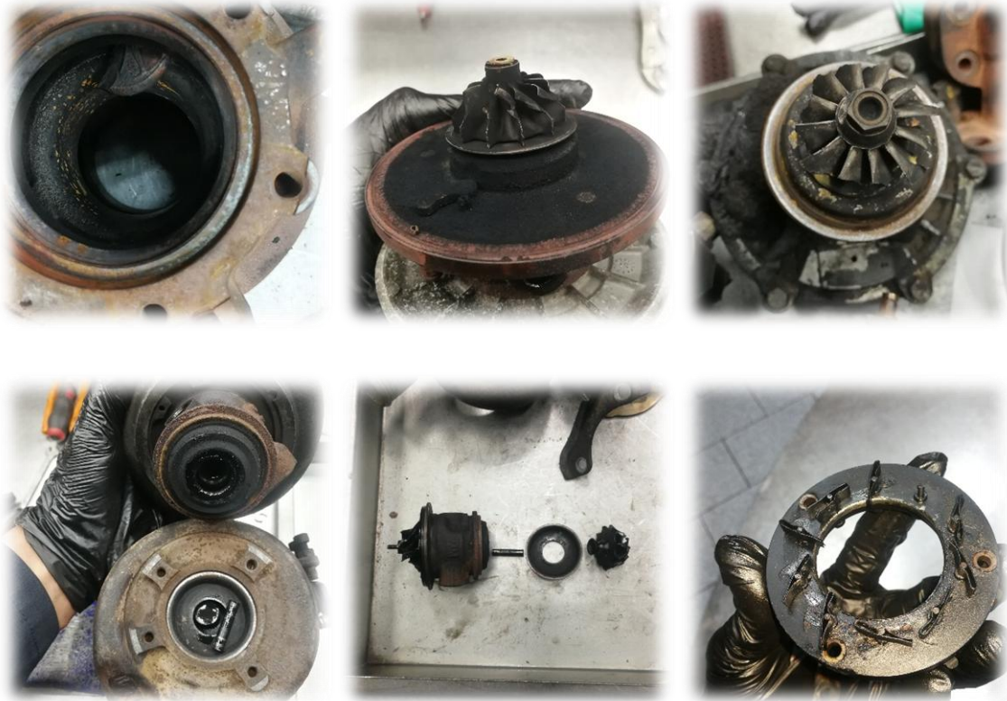
Figura 34 – Danos causados pela entrada do objetos estranhos pelo escape.
