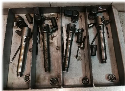
Figura 42 – Desmontagem de injetores VDO.
