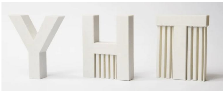
Figure 57 - YHT principle (Filament2Print 2022)
