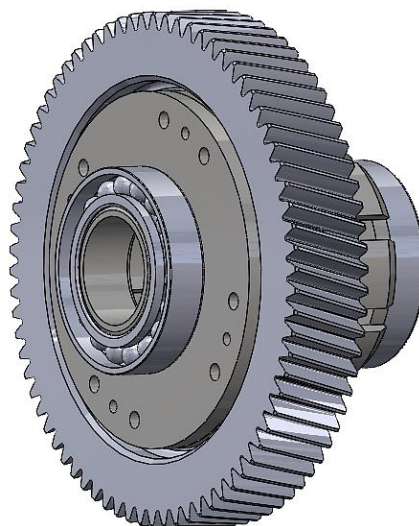
Figura 8.8 - Montagem do diferencial concluída
