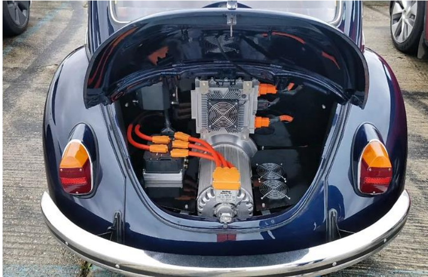
Figura 2.20 - Conversão de um veículo de combustão interna para elétrico [22]
