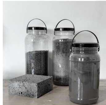
FIG.113 Basalto retificado, em grão e peneirado
