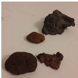
FIG.84 Cores do basalto após 1030°C. A pedra preta não foi para o forno.
