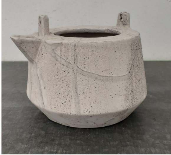
FIG.129 Erro de vidrado
