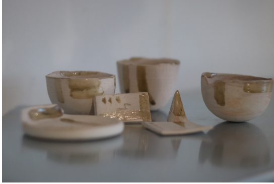
FIG.119 Amostras de grés com pó de basalto e vidrado com pó de basalto. 1030°C
