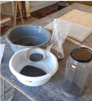
FIG.112 Basalto sendo peneirado
