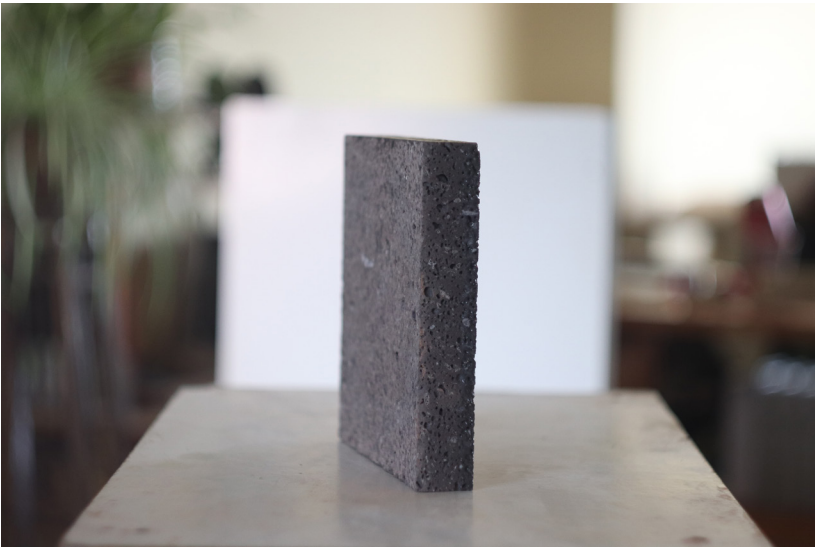
FIG.85 Basalto com superfície (esquerda) não vidrada após levado ao forno 1030°C
