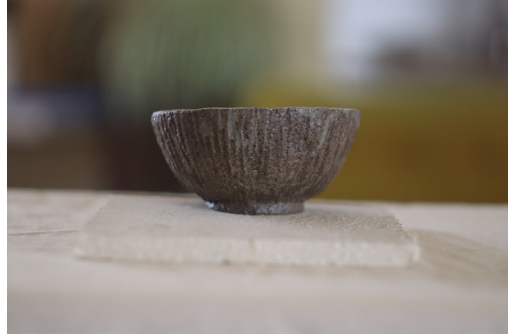
FIG.156 Peça de mistura de grés com basalto na pasta
