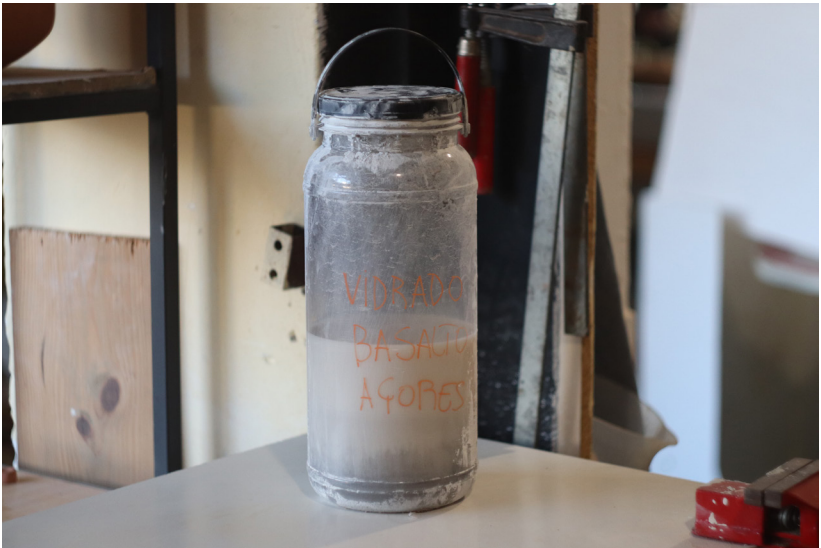
FIG.125 Recipiente com vidrado transparente mate para alta temperatura com pó de basalto.
