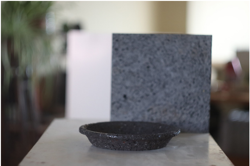
FIG.90 Prato após ir para o forno vidrar (frente) e basalto natural (fundo)
