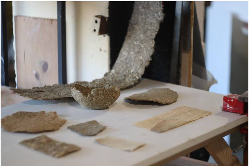
FIG.171. Testes com folha de milho triturados com cola e amostra da FIG.170
