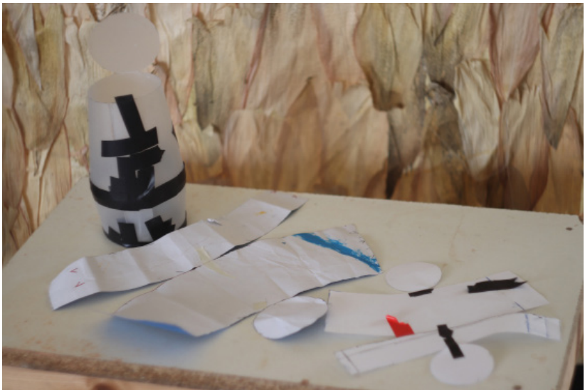
FIG.179 Gabarito da forma do molde em papel e molde montado
