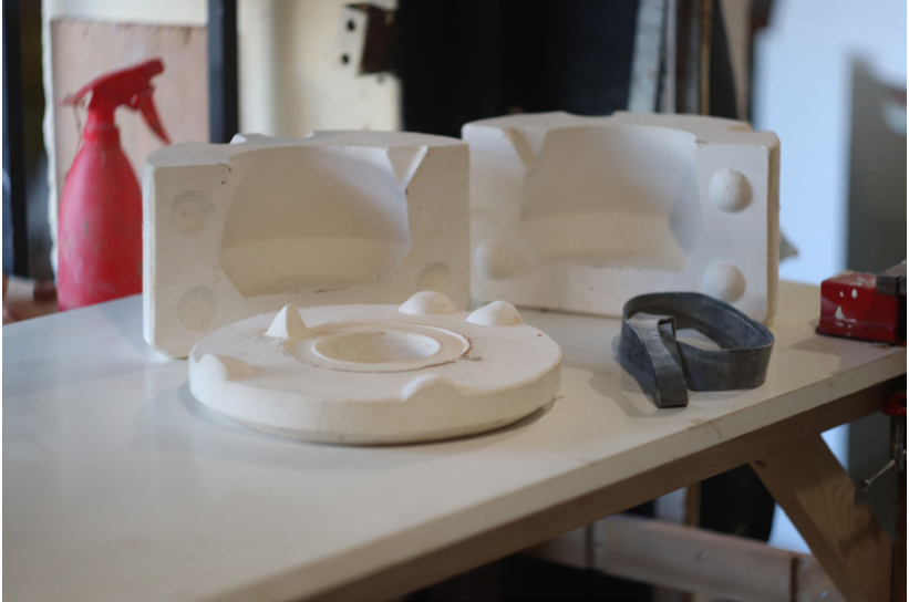
FIG.124 Molde do bule em 3 partes.
