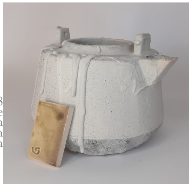
FIG.128 Vidrado aplicado. Teste de "excesso" e amostra de vidrado em baixa temperatura
