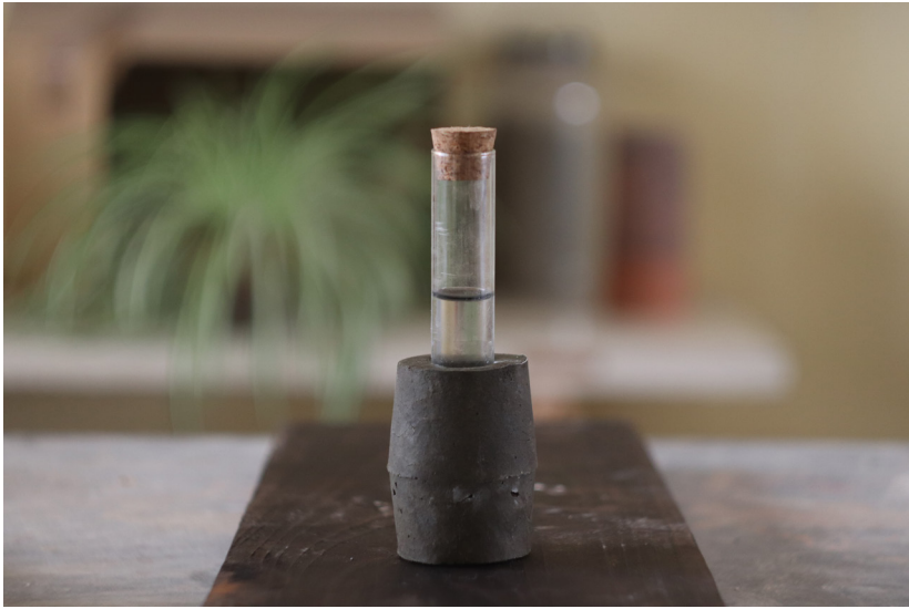
FIG.180 Teste pequeno por enchimento de molde
