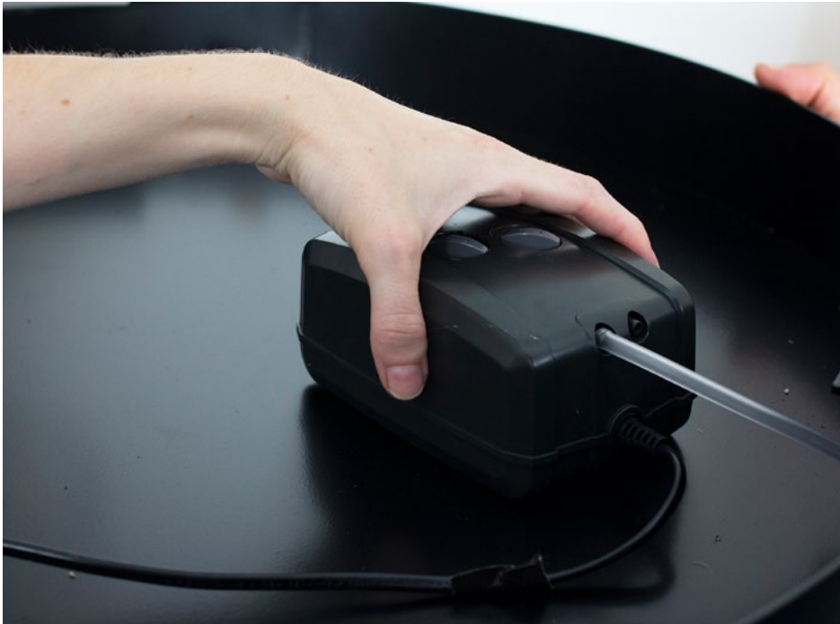
Fig. 159 Colocação da bomba de ar na caixa que reveste a estrutura.
