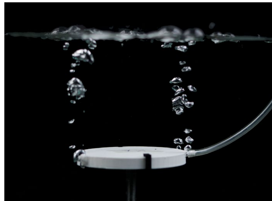
Fig. 94 Amostra conjunto 2, 7% preenchimento.
