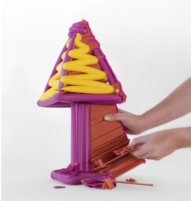
Figura 87. Remoção dos suportes estruturais do Modelo 9 - 1
