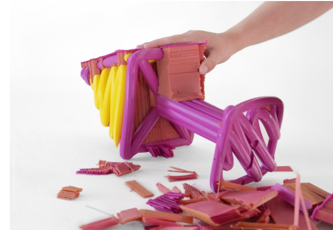
Figura 88. Remoção dos suportes estruturais do Modelo 9 - 2
