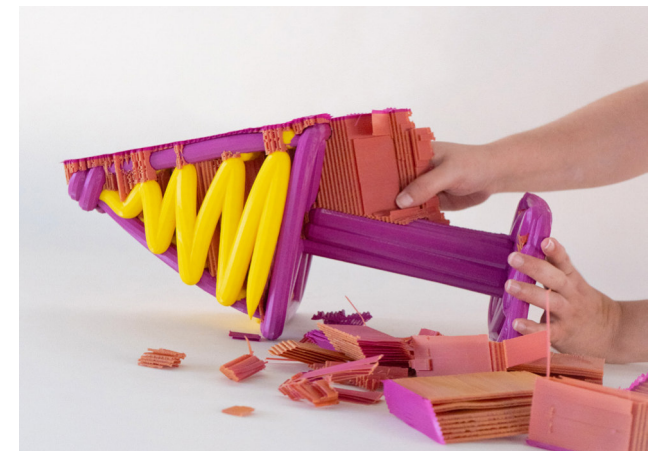
Figura 89. Remoção dos suportes estruturais do Modelo 9 - 3
