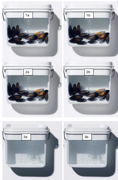
Figura 7.1: Desenho experimental do ensaio de biorremediação ( n=2 ). Grupo 1 – controlo formado por água salgada filtrada + 12 mexilhões; grupo 2 – água residual (proveniente da purga da aquacultura) + 12 mexilhões; grupo 3 – controlo formado por apenas água residual.
