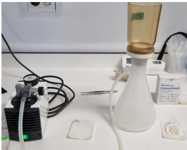
Figura 7.5: Dispositivo de filtração utilizado no ensaio, para medição do material particulado em suspensão.
