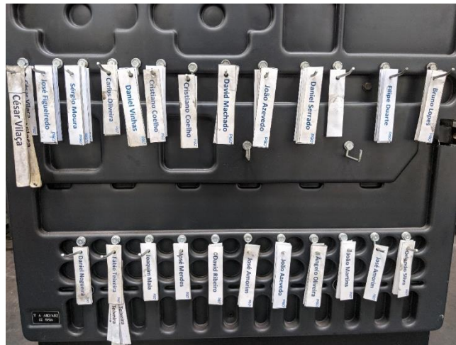
Figura 8 - Etiquetas utilizadas para marcação de local de ferramenta especial
