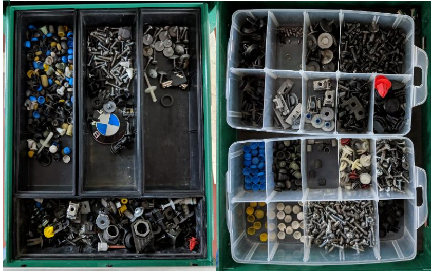
Figura 6 - Exemplo do antes e do depois da aplicação dos 5S nas bancadas de equipa
