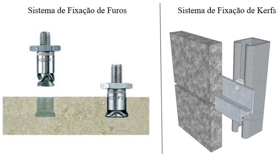
Figura 31 - Sistemas de Fixação de Furos e Kerfs [50] [51]
