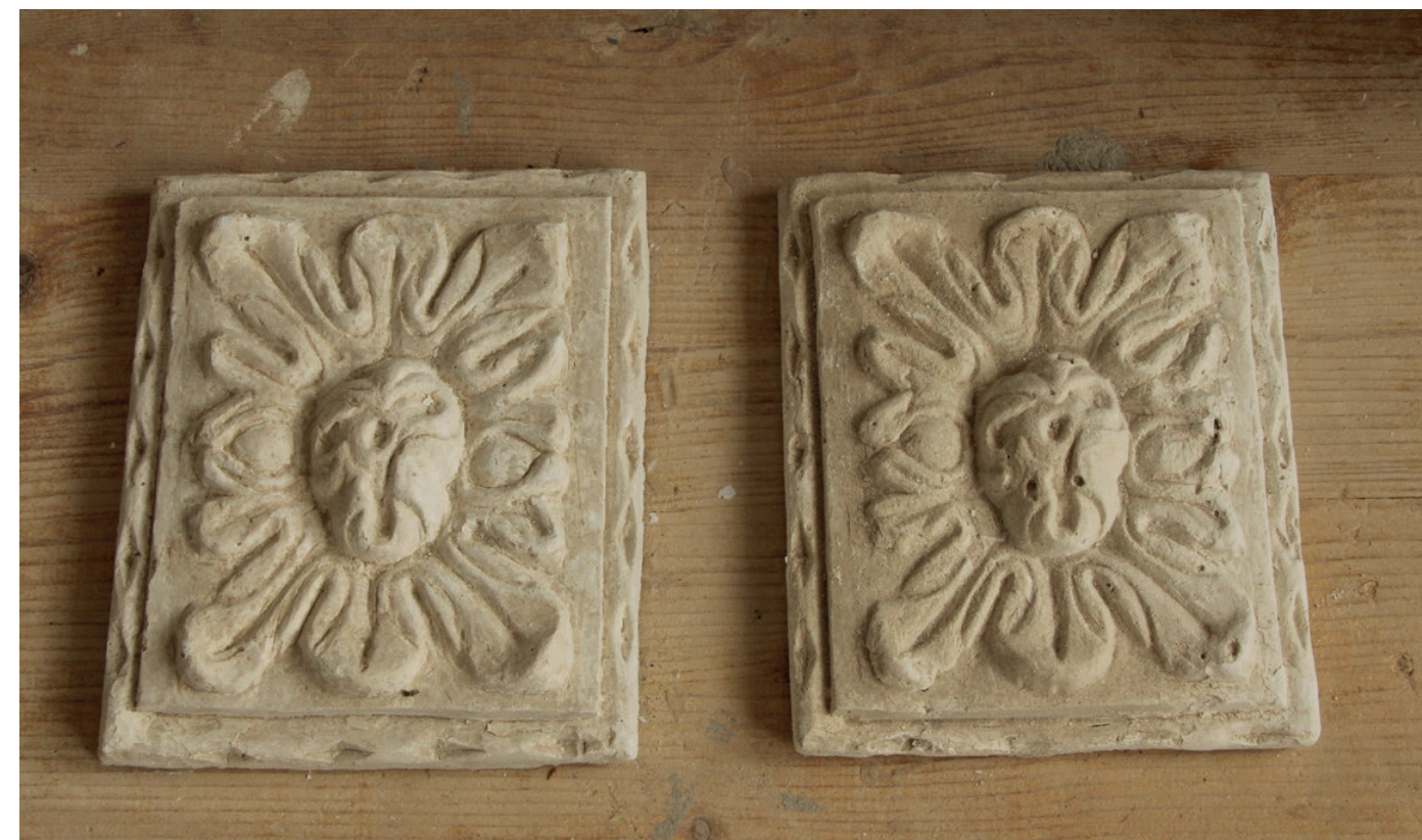
Fig. 17 - Molde em gesso para fundição. Fonte: "Os stuccos exteriores na região do Algarve", por M. Santos, 2016, p. 18.
