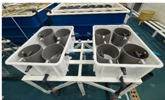
Figura 42 -Montagem do sistema experimental com dois upwellers e oito crivos circulares.
