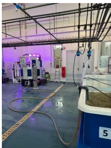
Figura 28 - Procedimento de inoculação de tanques na sala do Batch com o fotobiorreator (PBR).
