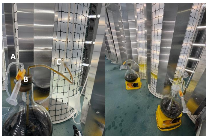
Figura 26 - Inoculação em linha na sala dos sacos. A. Entrada do ar; B. Saída do ar e C. Entrada da cultura.
