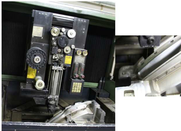
Figura 21 - Eletroerosão por fio
