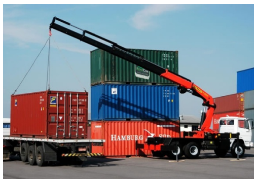
Figura 31 Camião de transporte e com grua.
