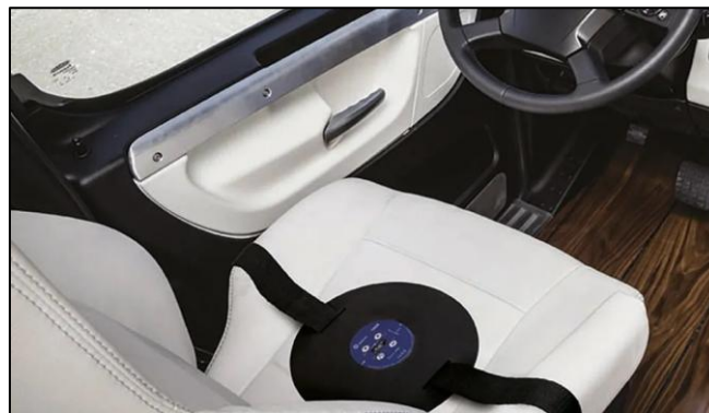
Figura 11 - Exemplo de um acelerômetro montado no assento de um veículo (Imagem retirada de [4])
