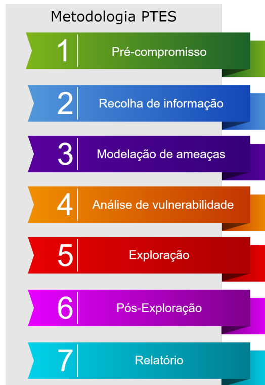
Figura 10: Fases do penetration testing do PTES (adaptado de [65])
