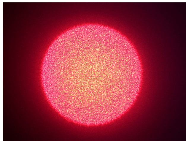
Figura 7: Exemplos de laser speckle , tendo como base um laser helium-neon (retirado de [20]).
