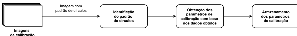
Figura 36: Pipeline do processamento realizado às imagens de calibração para cada câmara.
