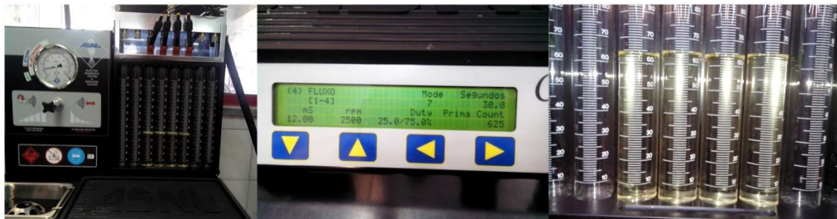
Figura 4.1 – Máquina de teste de injetores de gasolina e condições em que foi realizado o teste dos injetores.
