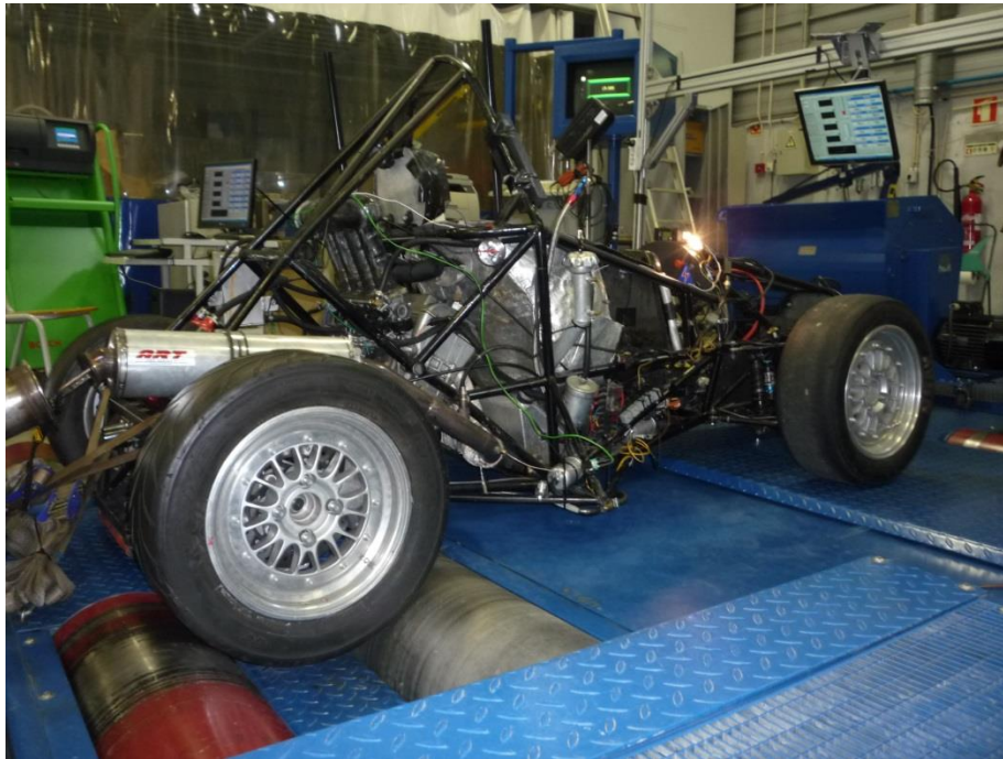
Figura 4.4 - Banco de potência MAHA LPS 2000 e montagem experimental no veículo em estudo.
