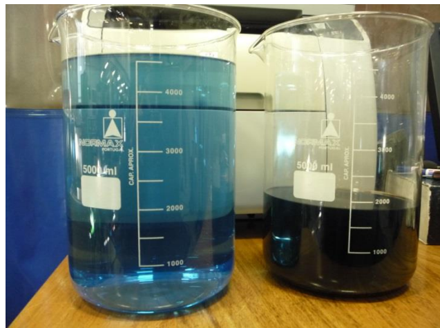
Figura 5.2 – Diferença de coloração entre E85 (à esquerda) e gasolina 98 (à direita).
