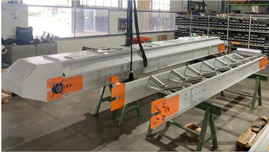
Figura 54 - Montagem dos 2 tapetes na zona da mecânica
