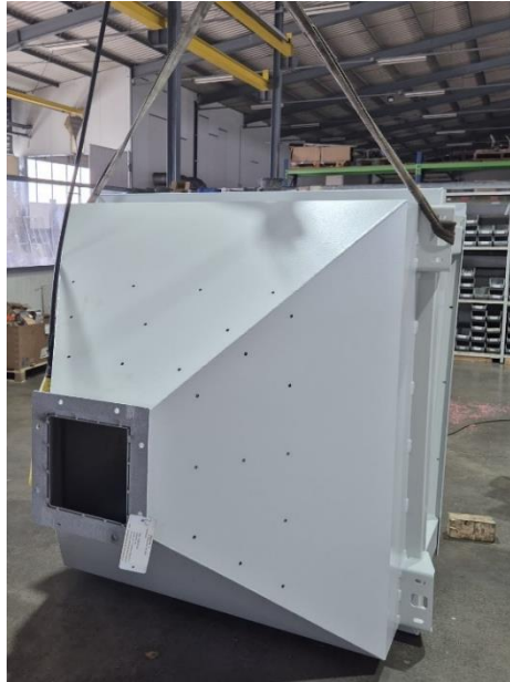
Figura 56 - Tremonha na zona da mecânica
