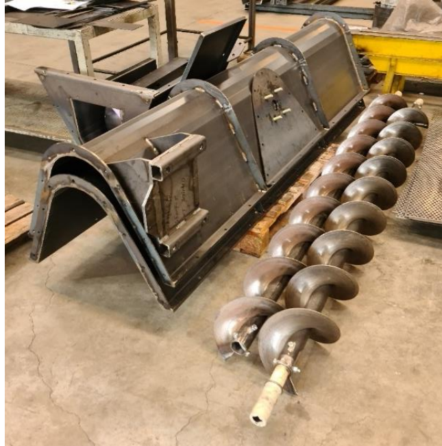
Figura 14 - Peças do sem-fim fabricadas e colocadas na secção de receção
