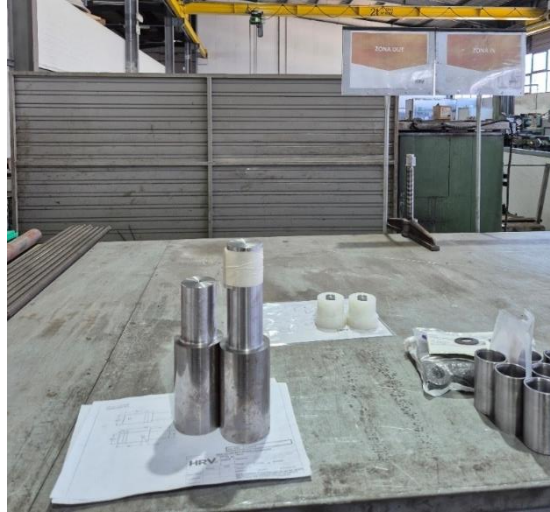
Figura 41 - Peças fabricadas na secção do torneamento na zona OUT
