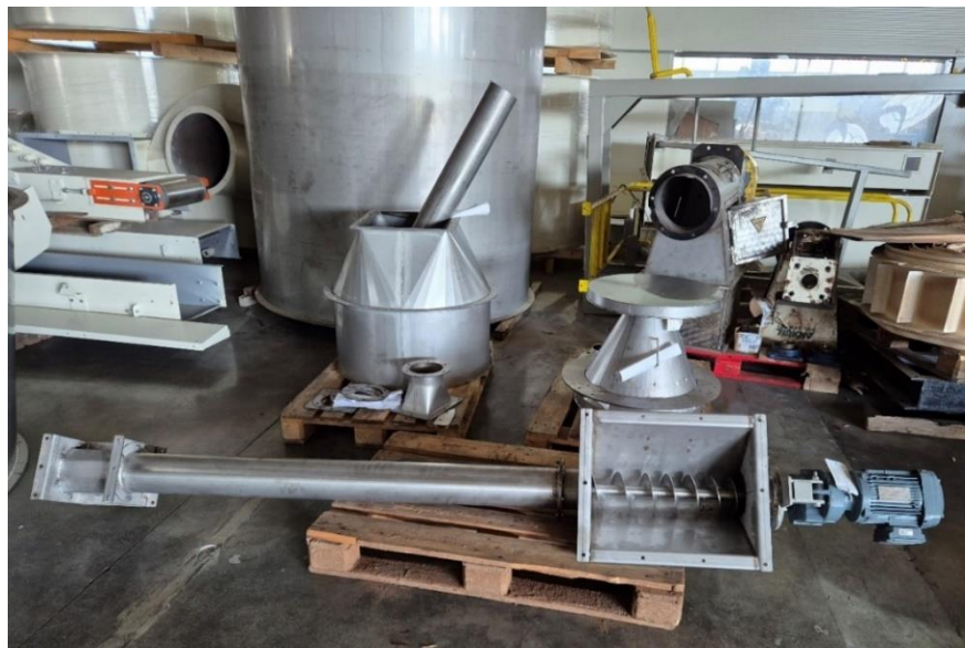
Figura 42 - Volume do sem-fim junto dos volumes de inox
