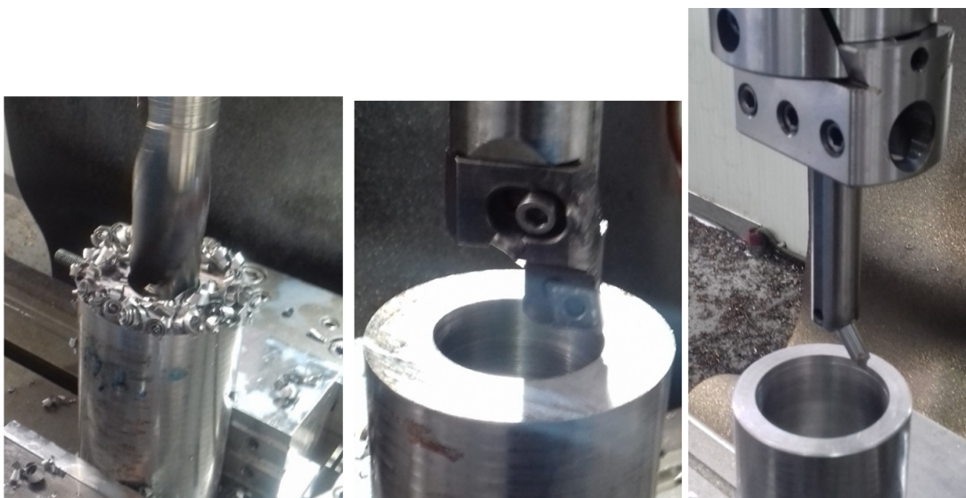
Figura 4.5: Desbaste e acabamento da caixa redonda no interior do aço
