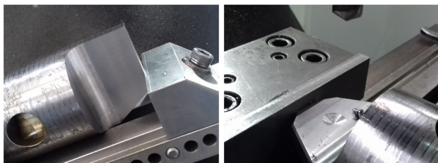
Figura 4.9: Chanfros e Furo central dos suportes
