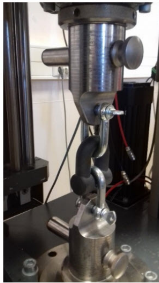
Figura 5.3: Ensaio de tração da peça otimizada
