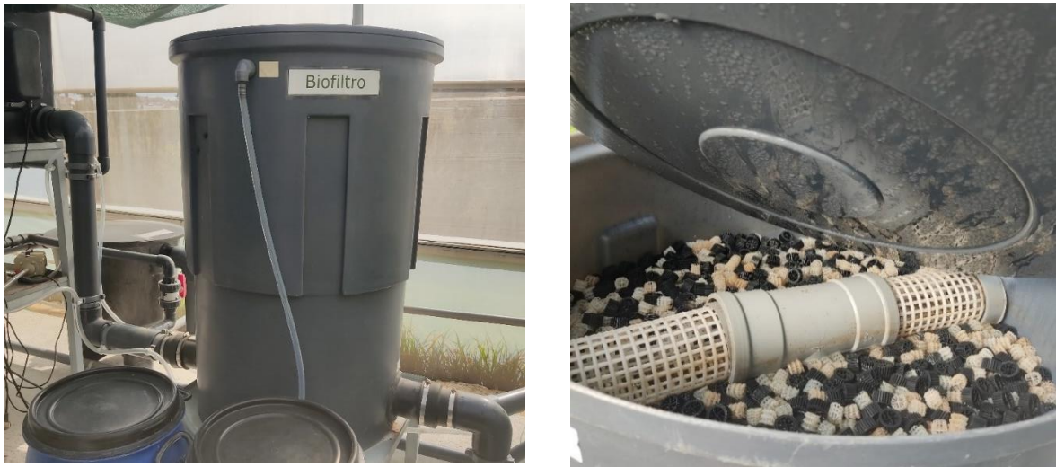
Figura 8- Tanque de Bio-bolas no Sistema de Aquaponia
