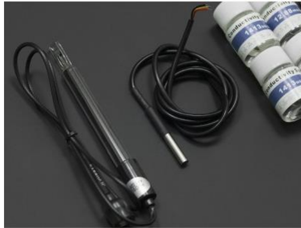
Figura 13- Sensor Analógico para Condutividade Elétrica. (Referência: SEN08024)
