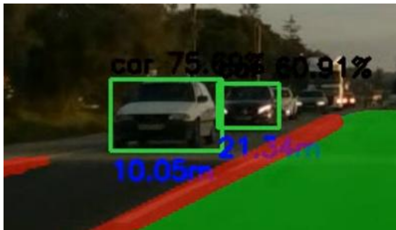
Figura 3-9 - Excerto de frame de deteção de objetos (YOLOv8).
