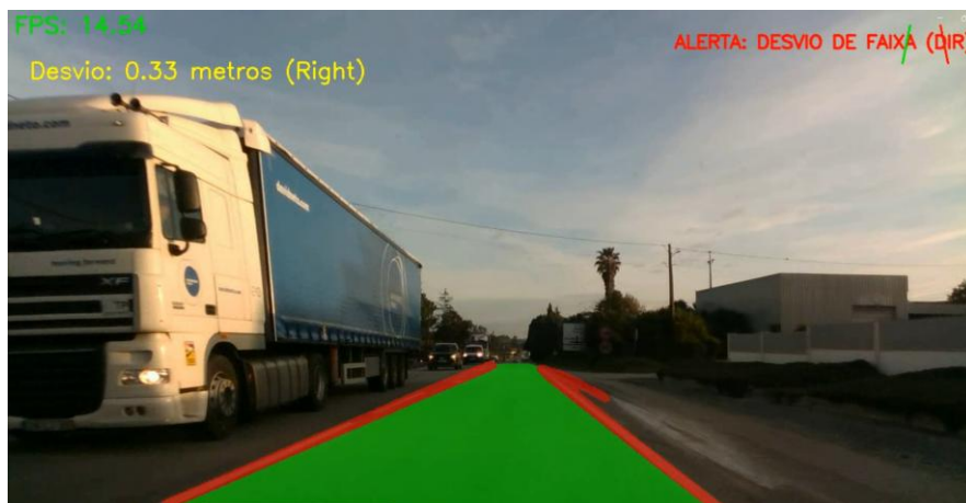
Figura 3-6 - Frame de teste de processamento de faixas de rodagem segundo Junsheng Fu.
