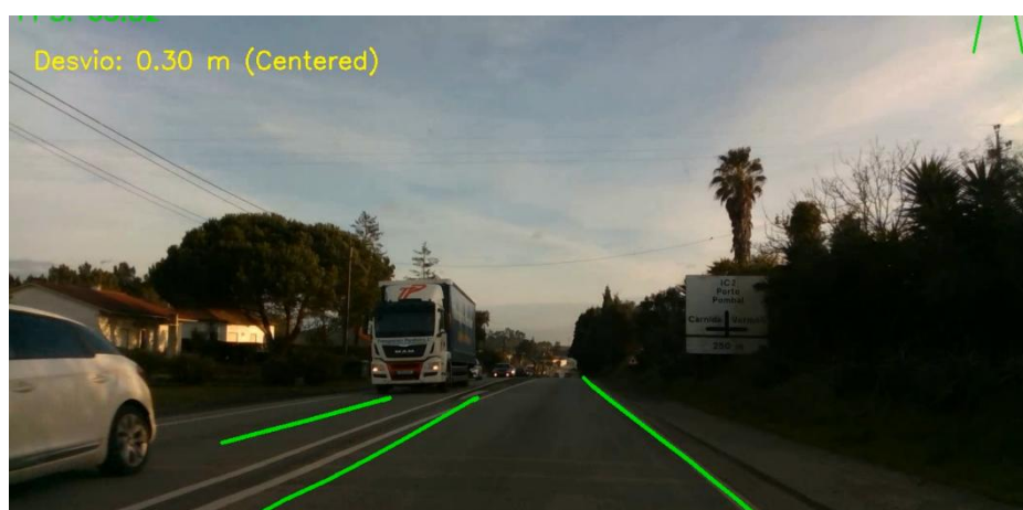
Figura 3-11 - Frame de saída de sistema de deteção baseado em UFLDv2 e YOLOv8.
