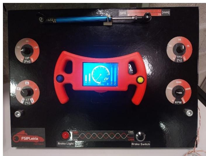
Figura 3-15 - Simulador de Linha CAN FSIPLeia.
