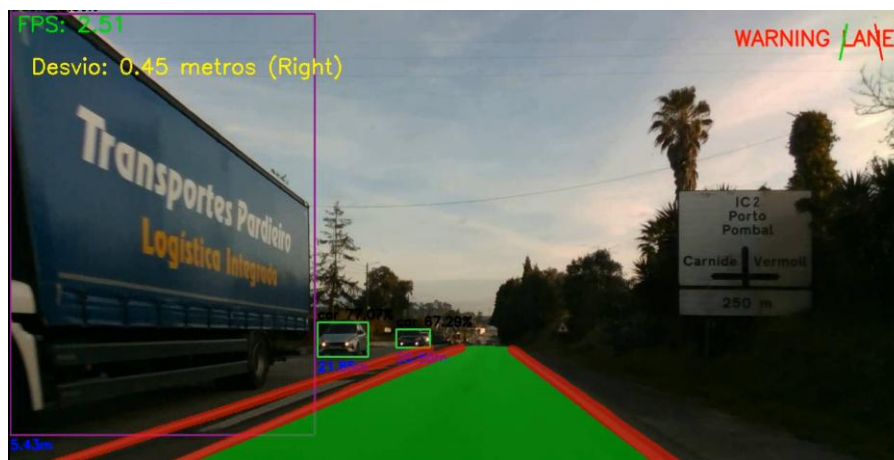
Figura 3-10 - Frame de saída de sistema de deteção baseado em YOLOPv2 e YOLOv8.
