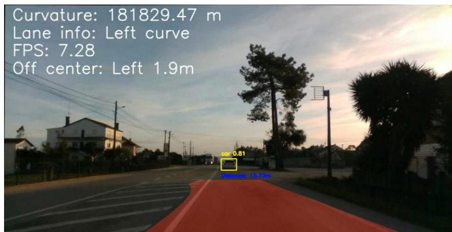
Figura 3-7 - Frame de teste de processamento da fusão entre deteção de faixas de rodagem e de objetos.
