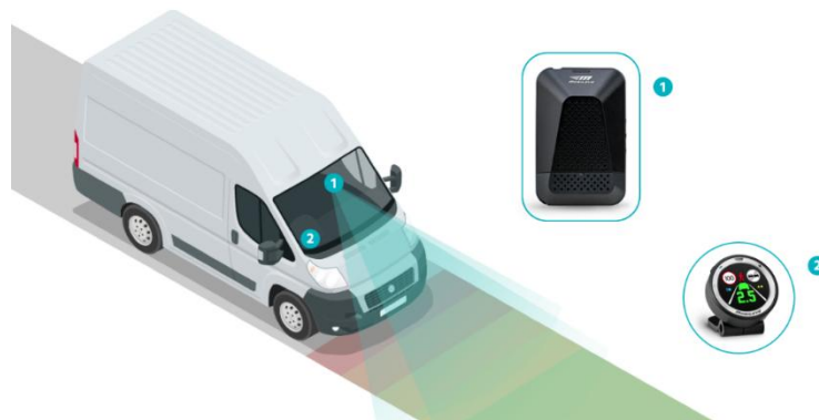
Figura 2-12 - Local de instalação do Mobileye 6 Series.
