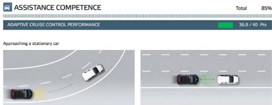
Figura 1-1 - Teste de performance de um sistema ACC de um Mercedes-Benz E400e.
