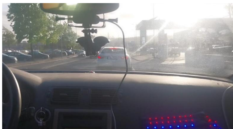
Figura 5-9 - Situação de perigo iminente alertada pelos avisos visuais
