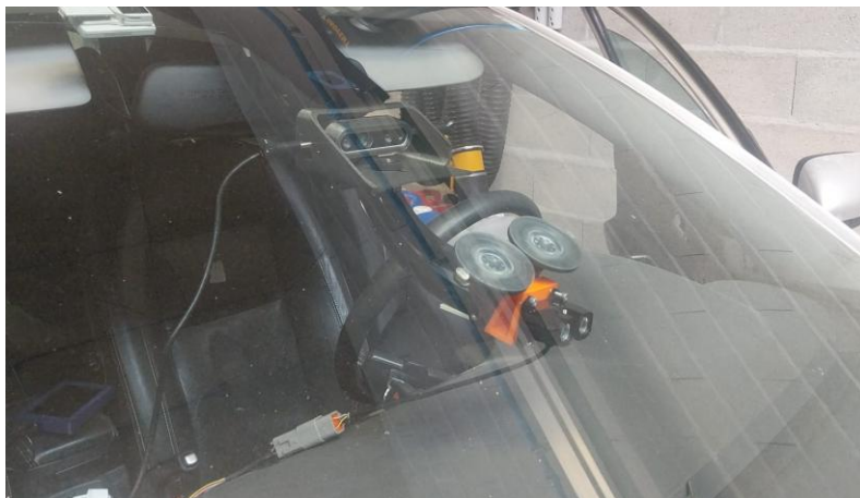
Figura 5-4 - Câmera e LiDAR instalados no interior do veículo.
