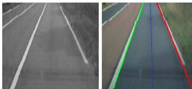
Figura 2-6 - Imagem de estrada processada pela Transformada de Hough.
