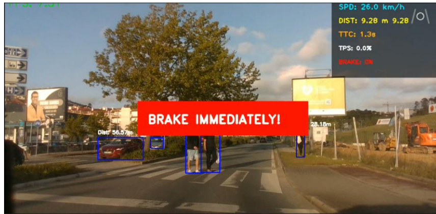
Figura 5-15 - Situação de perigo iminente envolvendo peões detetada pelo sistema com alerta visual.
