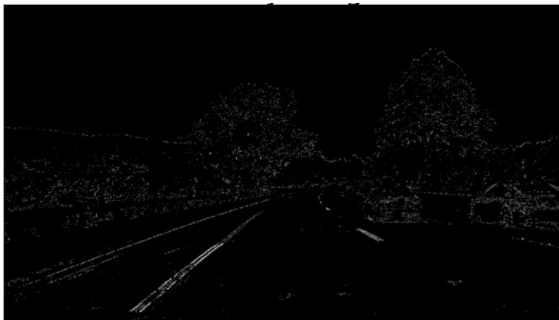
Figura 3-8 - Frame de imagem filtrada por gradientes. [18]
