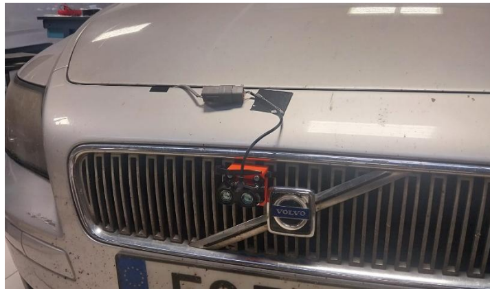
Figura 5-7 - Dispositivo LiDAR fixado na frente do veículo de teste.
