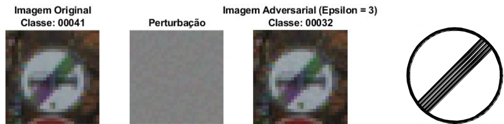
Figura 5.28: Resultado de classificação da imagem do sinal de trânsito de rótulo 00041 com o ataque FGSM para um \epsilon = 3 . À direita da imagem adversarial encontra-se a representação translúcida do sinal de trânsito classificado.
