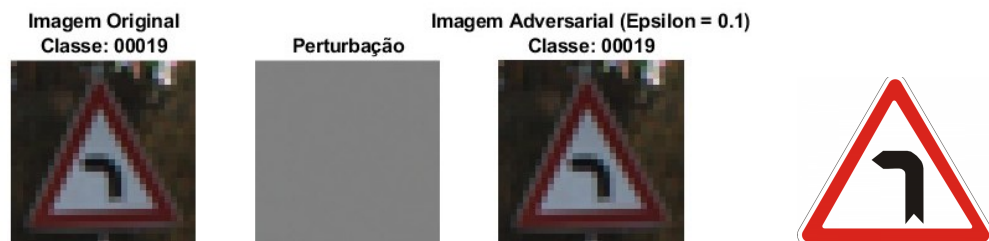
Figura 5.14: Resultado de classificação da imagem do sinal de trânsito de rótulo 00019 com o ataque FGSM para um \epsilon = 0.1 . À direita da imagem adversarial encontra-se a representação translúcida do sinal de trânsito classificado.
