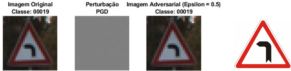
Figura 5.35: Resultado de classificação da imagem do sinal de trânsito de rótulo 00019 com o ataque PGD para um \epsilon = 0.5 . À direita da imagem adversarial encontra-se a representação translúcida do sinal de trânsito classificado.
