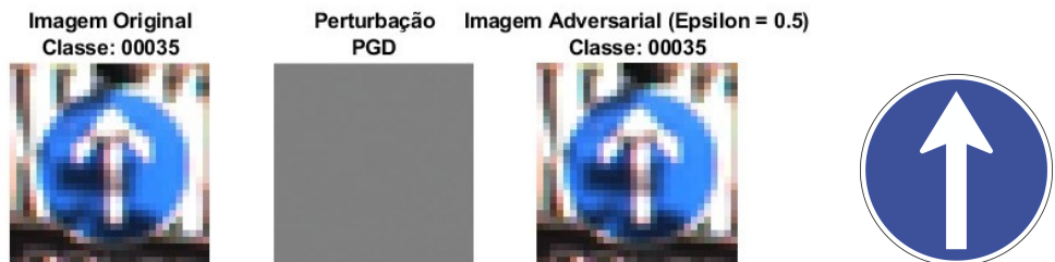
Figura 5.40: Resultado de classificação da imagem do sinal de trânsito de rótulo 00035 com o ataque PGD para um \epsilon = 0.5 . À direita da imagem adversarial encontra-se a representação translúcida do sinal de trânsito classificado.
