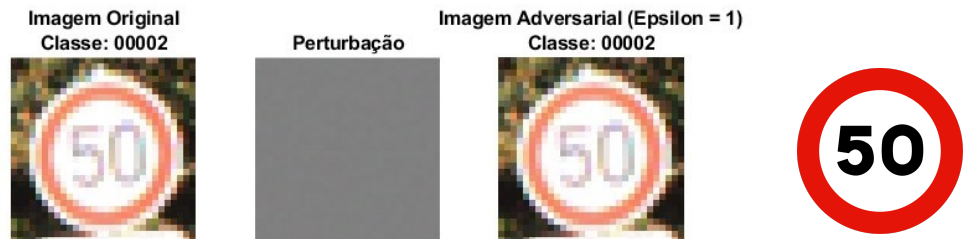
Figura 5.11: Resultado de classificação da imagem do sinal de trânsito de rótulo 00002 com o ataque FGSM para um \epsilon = 1 . À direita da imagem adversarial encontra-se a representação translúcida do sinal de trânsito classificado.
