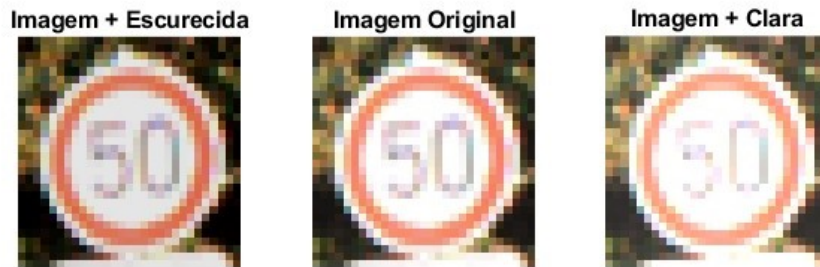
Figura 5.49: Ilustração de uma imagem de sinal de trânsito para a aplicação do método ImageStar com a criação do conjunto de valores de entrada entre uma imagem mais escurecida ( lower bound ) e uma imagem mais clara ( upper bound ).
