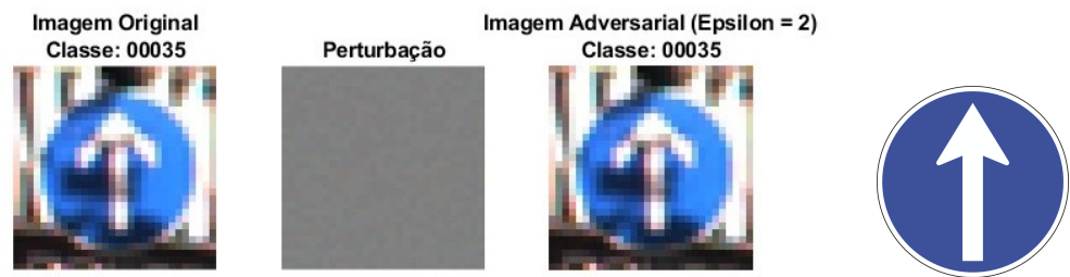
Figura 5.22: Resultado de classificação da imagem do sinal de trânsito de rótulo 00035 com o ataque FGSM para um \epsilon = 2 . À direita da imagem adversarial encontra-se a representação translúcida do sinal de trânsito classificado.
