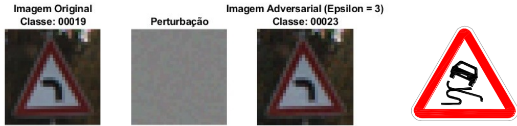
Figura 5.18: Resultado de classificação da imagem do sinal de trânsito de rótulo 00019 com o ataque FGSM para um \epsilon = 3 . À direita da imagem adversarial encontra-se a representação translúcida do sinal de trânsito classificado.
