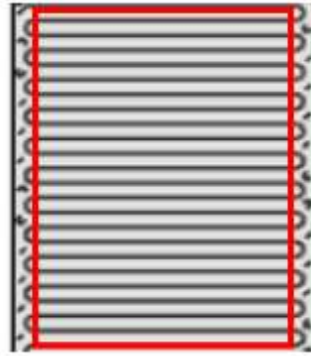
Figura 3.13 - Representação da transição de sentido da deposição do filamento no processo de MEX.
