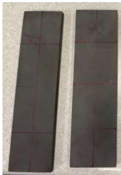
Figura 4.8 - Provete A e B marcados com as linhas nodais para o modo de vibração flexional e torcional.
