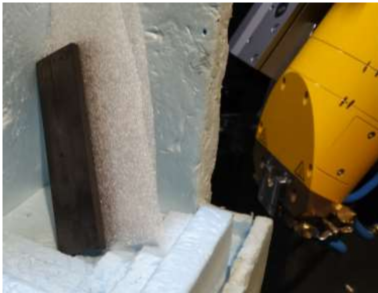
Figura 4.14 - Provetes posicionados e separados por espuma de baixa densidade dentro do equipamento de Micro-CT.
