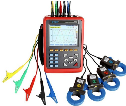
Figura 13 – Analisador de energia eléctrica ETCR 5000 13
