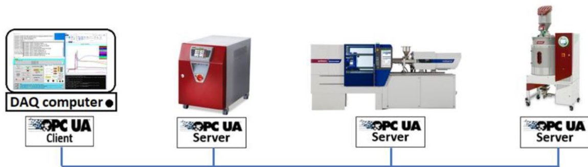
Figura 3 - Rede de comunicação com o protocolo OPC UA 3
