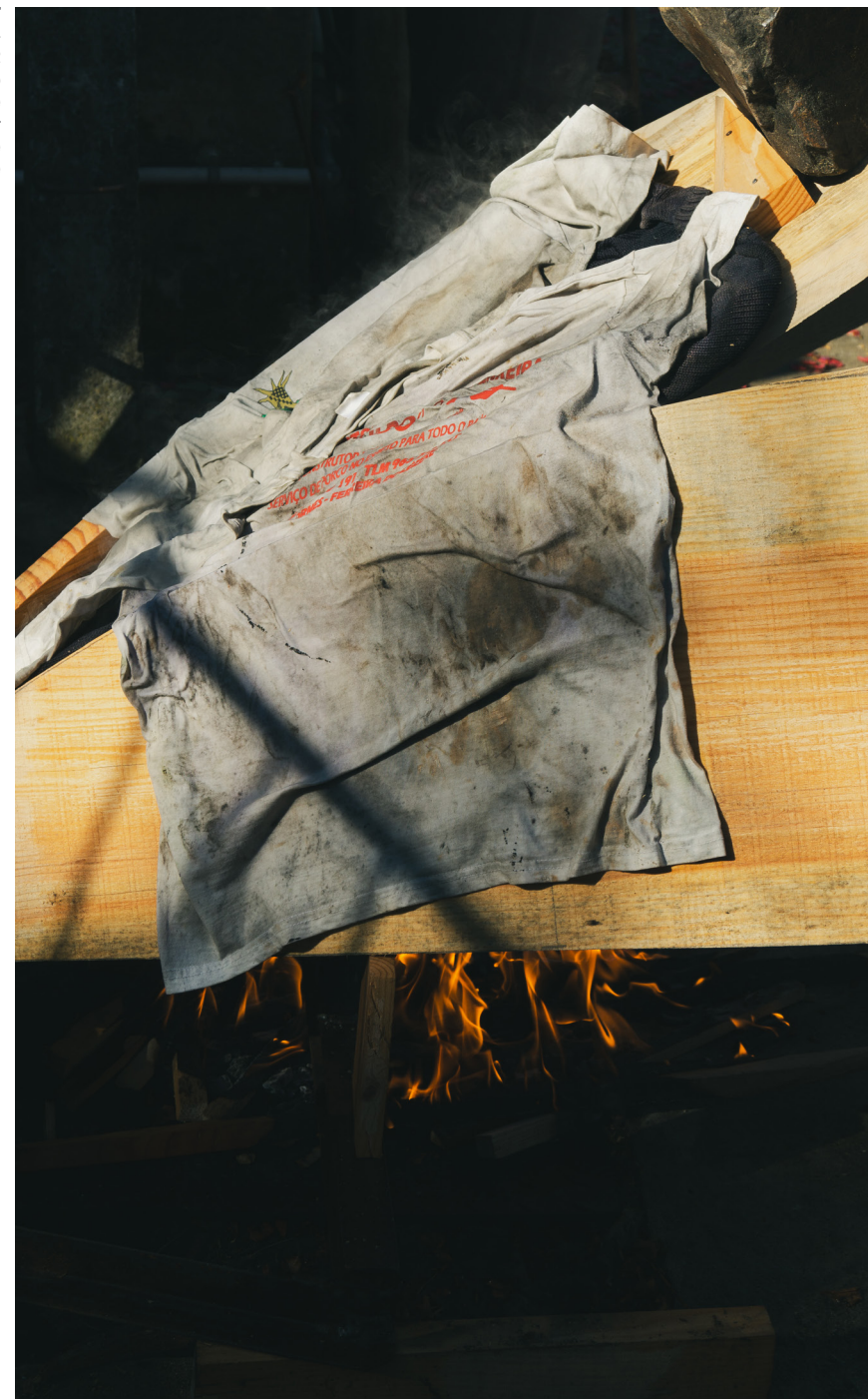
Figura A34 Fase 2 Dobramento Utilização de panos para mater os níveis de humidade
