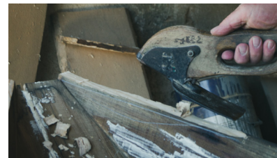
Figura A63 Utilização da enxada para fazer o encaixe das tábuas superiores da proa
