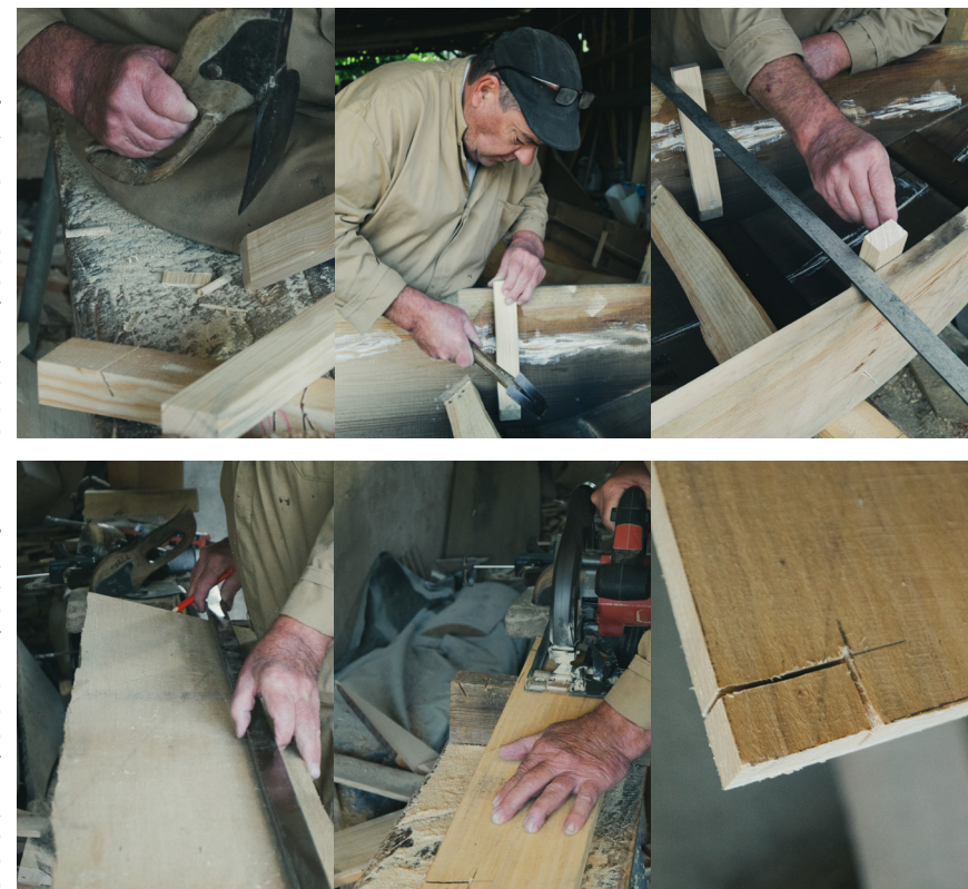
à esquerda Figura A41 Utilização da enxó
