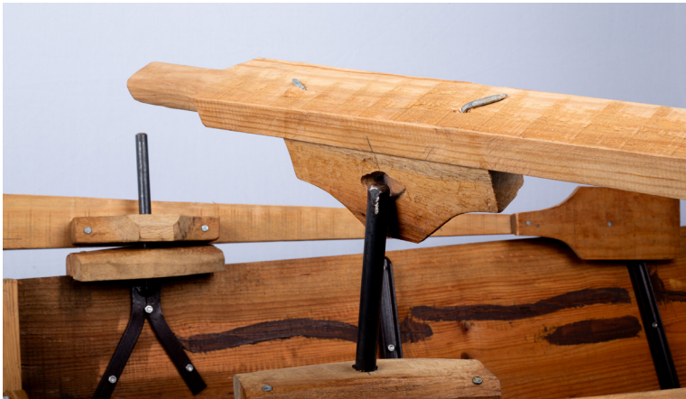
Figura 90 Encaixe do remo nas chamas
