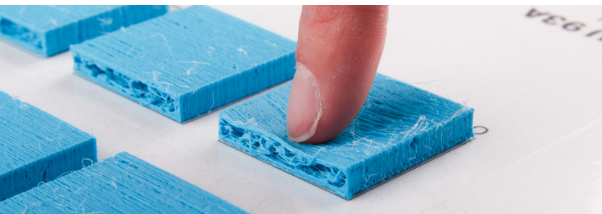
Figura 157 Teste da amostra com TPU 82A, com padrão geométrico Lightning
