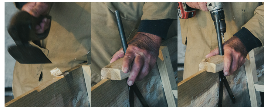
à esquerda Figura A77 Corte na estrutura para encaixar a chumaceira
