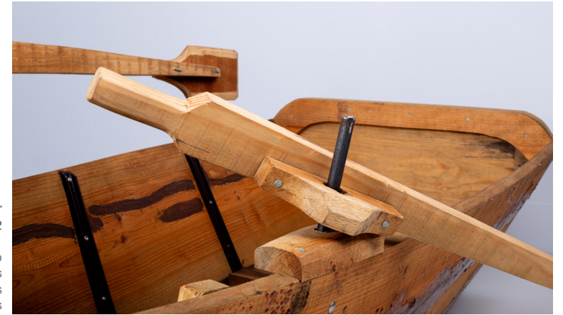
Figura 92 Pormenor do encaixe dos remos e das chamas
