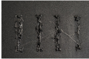
Figura 154 Teste de impressão com TPU 60A
