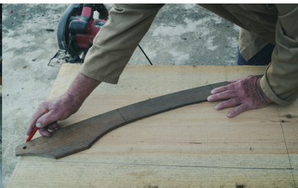
à esquerda Figura A22 Definição das dimensões das costaneiras à direita Figura A23 Utilização do molde para desenhar a proa
