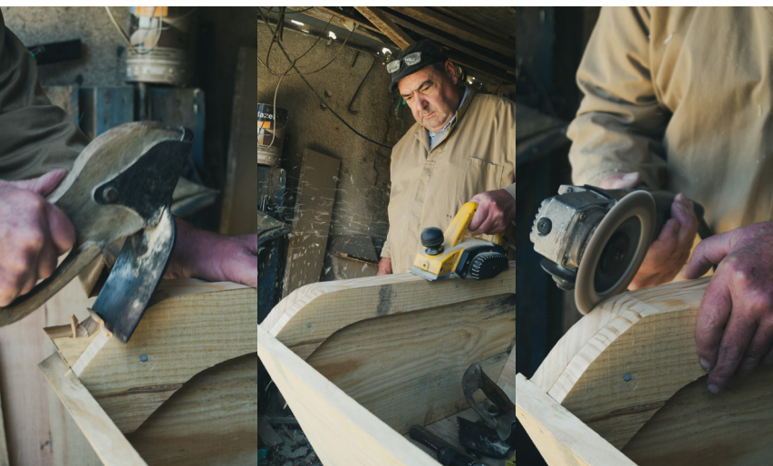
à esquerda Figura A60 Utilização da enxada para pormenores
