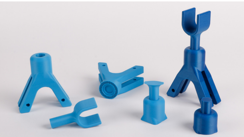
Figura 205 Testes de Impressão em ASA e PETG.
