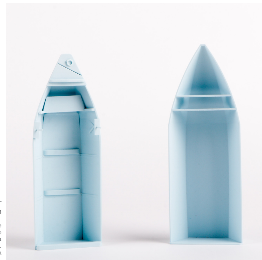
Figura 133 Comparação entre o barco construído no workshop e a estrutura otimizada. Modelos impressos à escala 1/10 em PLA.
