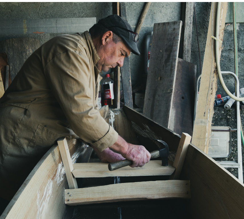
Figura A47 Fixação do banco do remador
