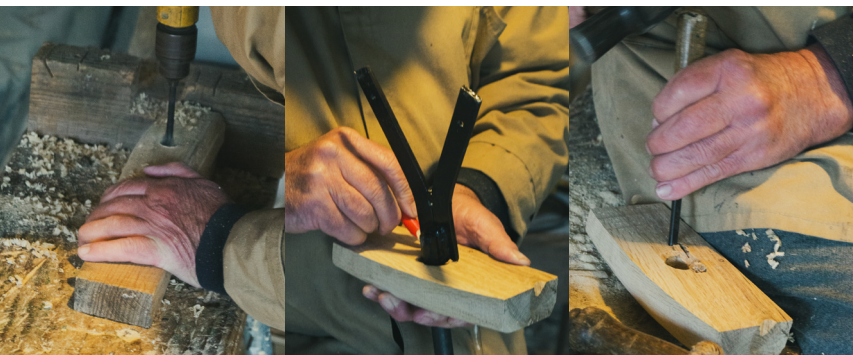
à esquerda Figura A74 Abertura do encaixe das chamas nas chumaceiras
