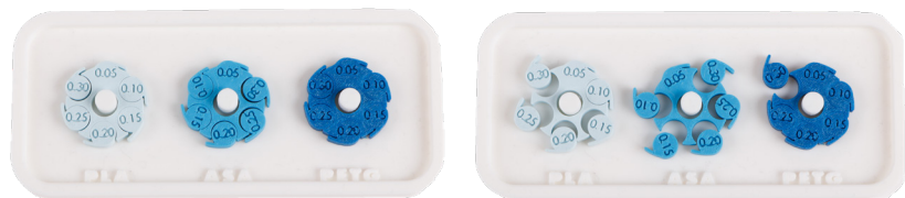
Figura 206 e 207 Amostras com diferentes tolerâncias em PLA, ASA e PETG
