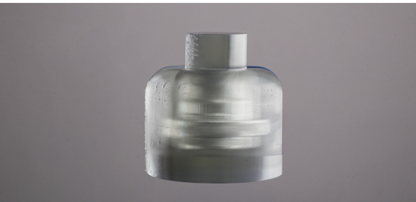
Figura 199 Modelo de teste em resina do mecanismo em estudo
