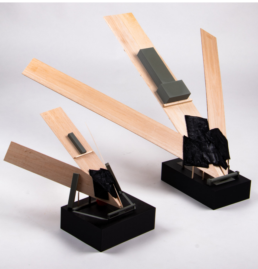
Figura 101 Maquetes de comparação à escala 1/5 do enquadadoiro novo vs o antigo na fase 2: Processo do dobramento
