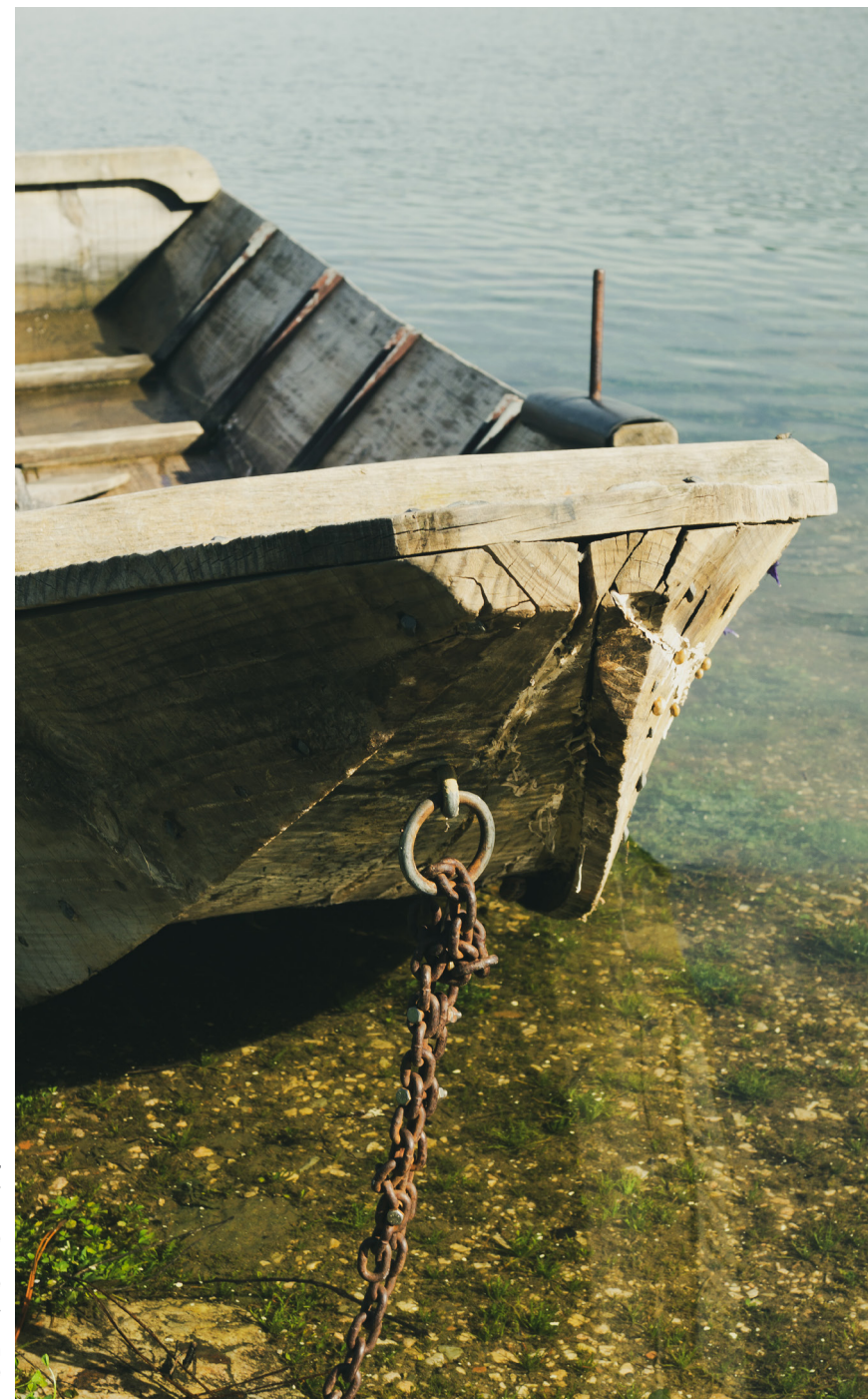
Figura 27 Barco de três tábuas, destaque sob a proa e o argolão. Bairrada em março de 2024.
