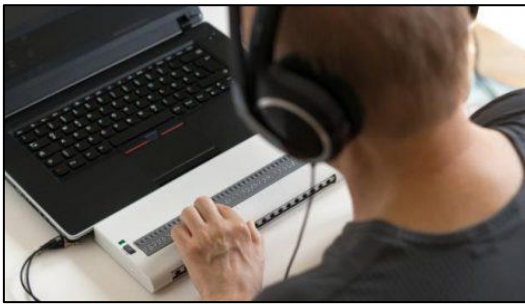
Figura 4 - Exemplo da utilização do leitor de ecrã num computador com uma linha Braille 4
