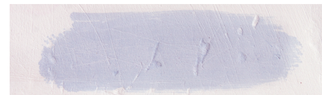
Figura 28 | Experiência nº 81. Cor resultante na faiança após adsorção da emulsão extraída da couve-roxa.
