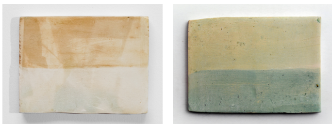
Figura 23 | Experiência nº 80 (à esq.) e nº 17 (à dir.). Diferença entre a aplicação de várias camadas de emulsão (metade superior das peças) e uma camada de emulsão (metade inferior das peças).
