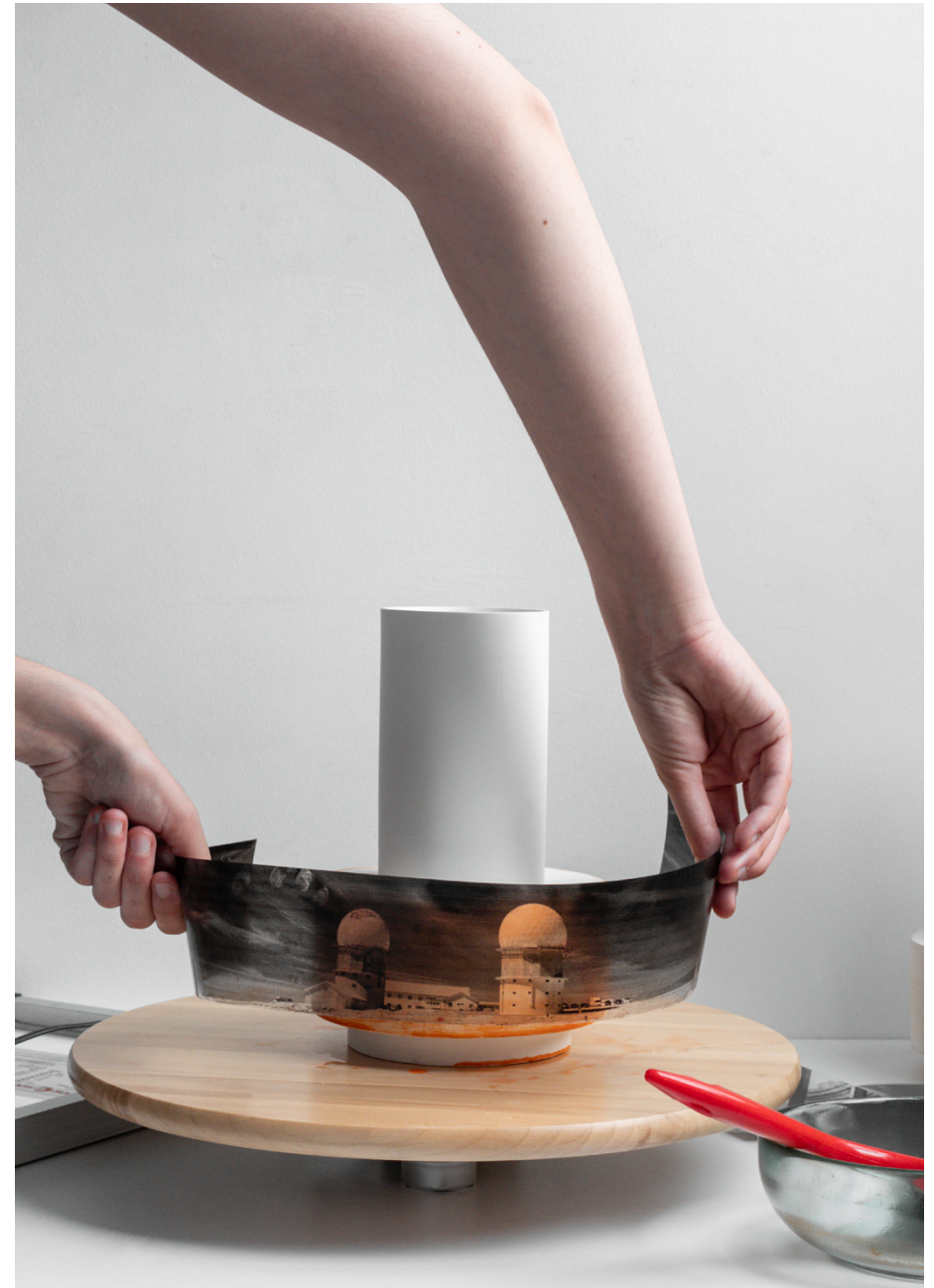
Figura 84 | Colocação do acetato em redor da peça.
