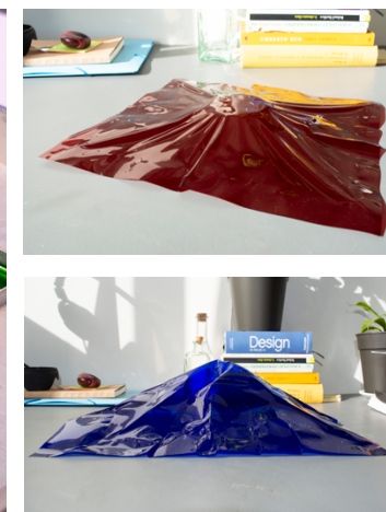
Figura 65 | Resultado da tentativa de termoformar uma folha de filtro ‘E-colour’ (em cima) e ‘supergel’ (em baixo).
