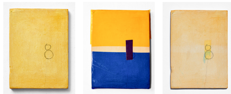
Figura 56 | Experiência nº 46. Disparidade de resultados a nível de cor, obtidos através da utilização de filtros com cor distinta. Da esquerda para a direita: peça após absorção da emulsão; peça após colocação dos filtros; peça após 4 dias de exposição à luz com os filtros.
