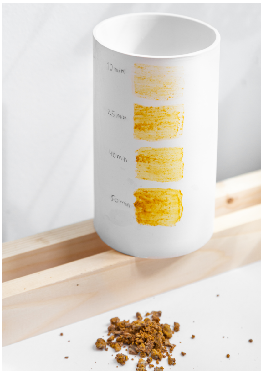
Figura 13 | Experiência sobre o nível de saturação obtido em relação ao tempo de fervura de açafrao em pó (10, 25, 40 e 50 minutos).
