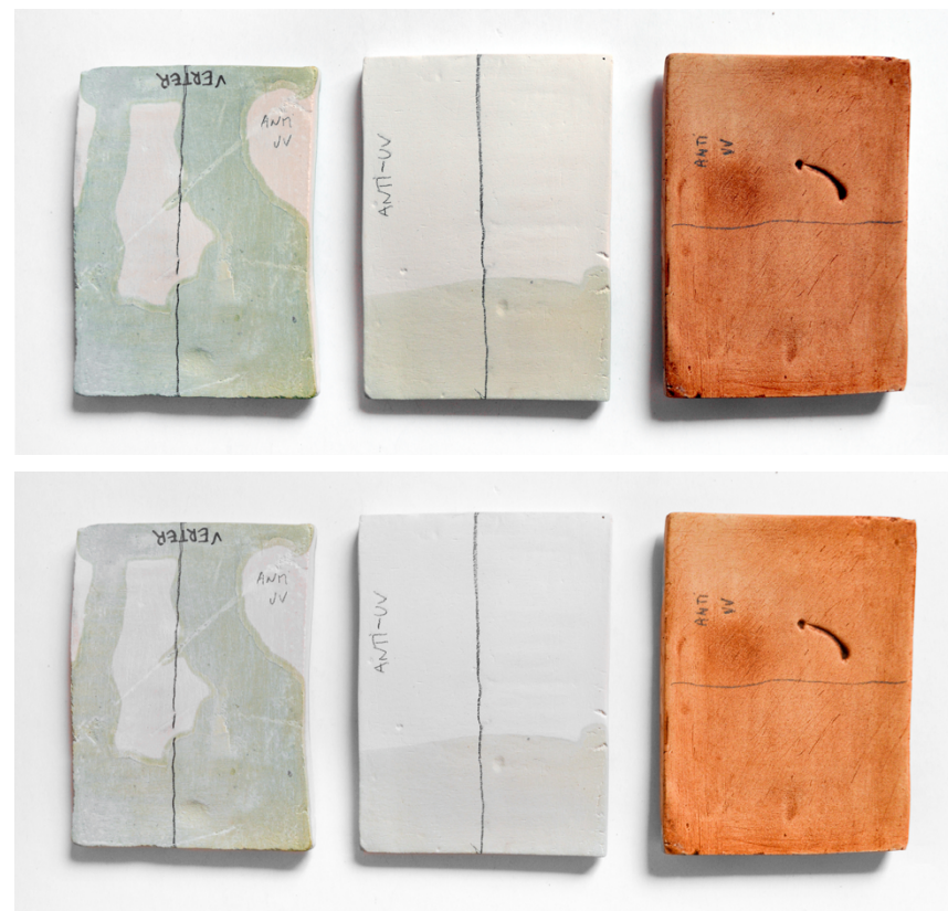
Figura 37 | Experiências nº 3, nº 25 e nº 19 (enumeradas da esquerda para a direita). Resultado da aplicação de spray anti-uv em metade das peças- após 2 dias (fila de cima) e 4 dias de exposição (fila de baixo).
