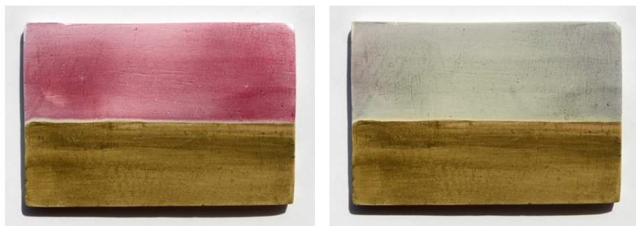
Figura 27 | Experiência Nº 63 (metade superior da peça). Mudança repentina da cor na peça após aplicação da emulsão fotossensível.
