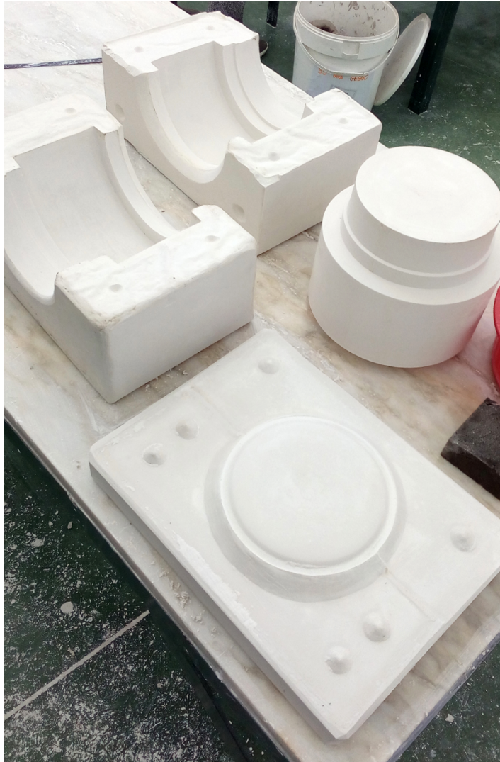
Figura 72 | Modelo em gesso de uma das peças e respetivo molde.
