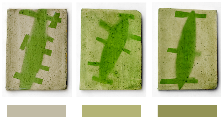
Figura 55 | Experiências nº 5, nº 6 e nº 7. Comparação das tonalidades de várias peças expostas a diferentes comprimentos de onda - Papel celofane verde, papel celofane azul, sem filtro (da esquerda para a direita).
