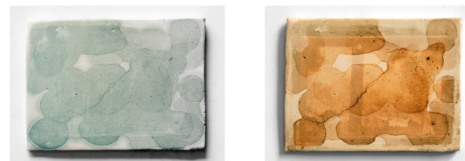
Figura 24 | Experiência nº 44. Variações de cor apresentadas na peça antes (à esq.) e após exposição à luz (à direita).
