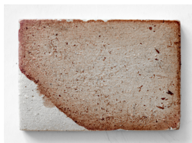
Figura 42 | Experiência nº 31. Teste de absorção da emulsão em grés chamotado.
