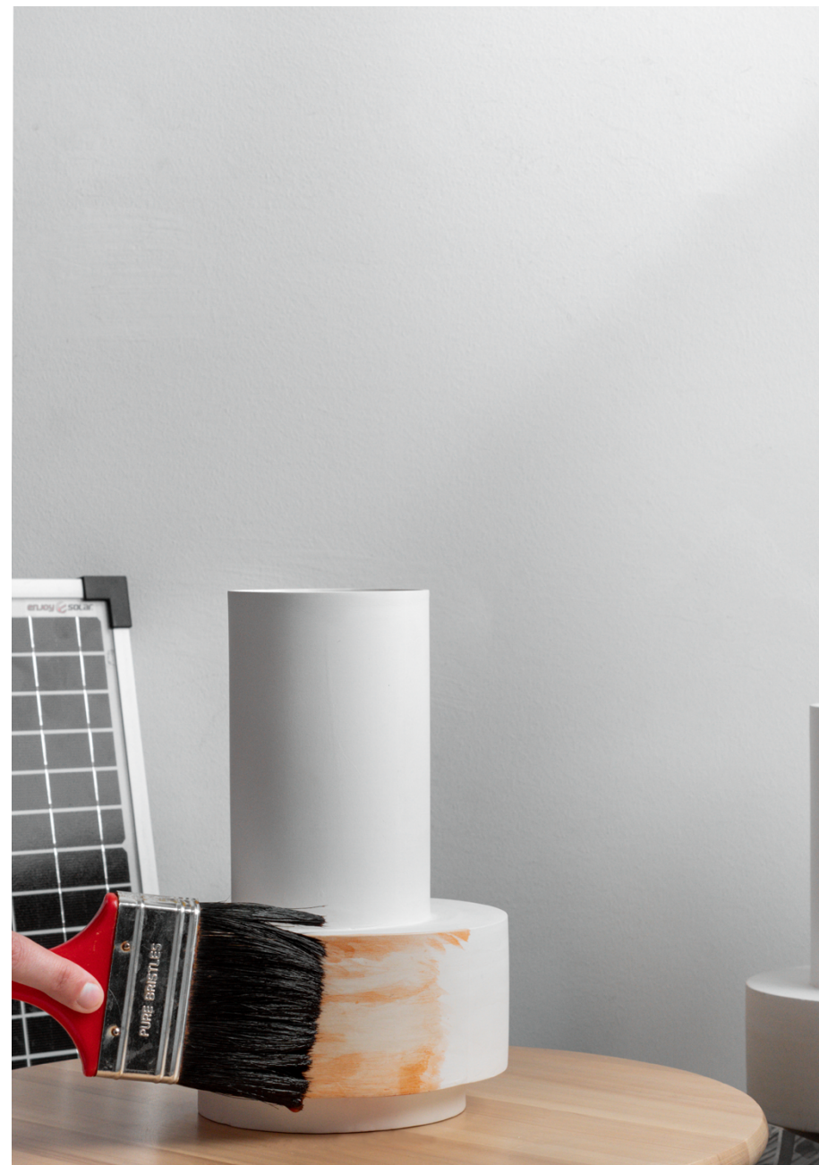
Figura 80 | Processo de aplicação da emulsão (é utilizada a rotação da plataforma para aplicar a emulsão de forma uniforme).
