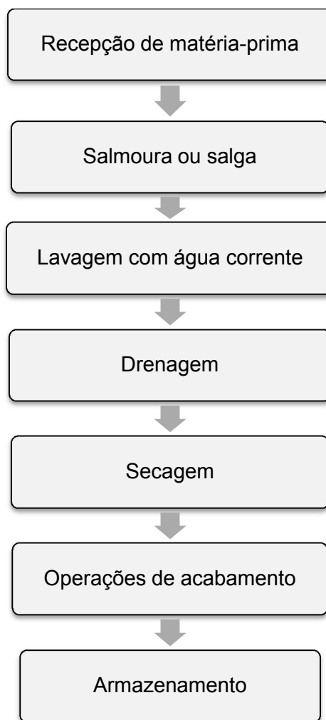
Figura 2 - Etapas principais de secagem de pescado. (Adaptado de Berkel, 2005; Arvanitoyannis & Kotsanopoulos, 2012).
