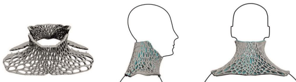
Figura 7 – Modelo 3D para impressão
