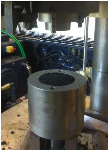
Figura 52 - Molde para elemento do pino preenchido com compósito.
