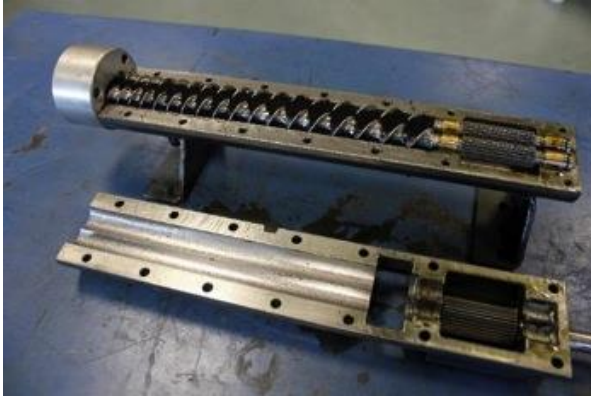
Figura 51 - Duplo-fuso de mistura e transporte.
