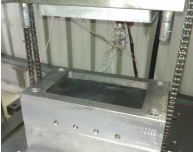
Figura 63 - Molde aberto após cura.
