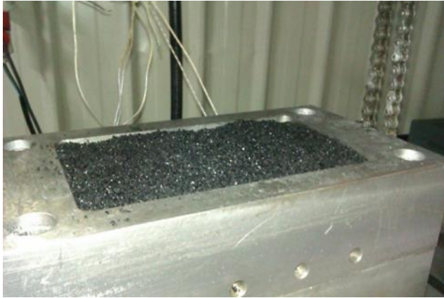
Figura 61 - Molde com mistura depositada.
