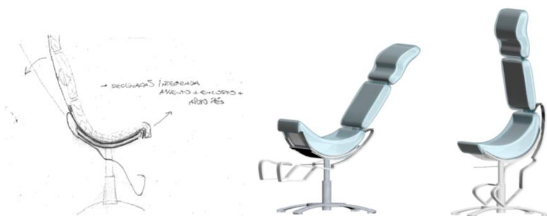
Figura 42 – Sistema de reclinção
