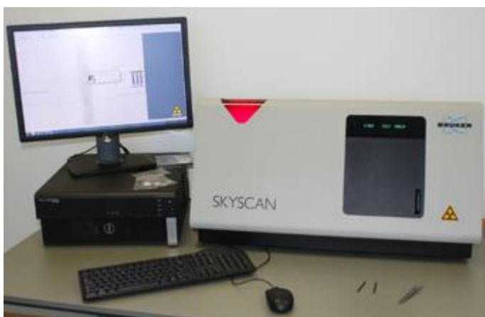
Figura 57 - Equipamento de MicroCT (tomografia).
