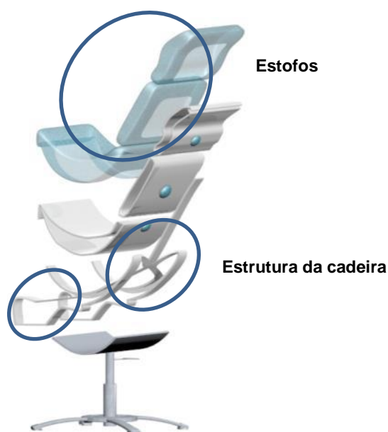
Figura 41 a) Estofos e b) Estrutura da cadeira
